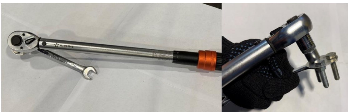
Рисунок 42 – Экспериментальное исследование, где а – динамометрический ключ Airline ATBN001; б – затяжка болтов [фото автора]
