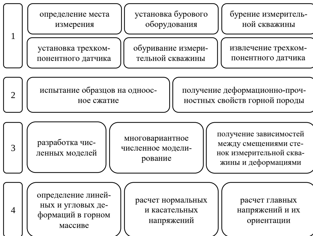
Рисунок 1 – Схема метода оценки напряженного состояния горного массива. Этапы выполнения: 1 – натурные испытания; 2 – лабораторные испытания; 3 – численное моделирование; 4 – аналитический расчет
