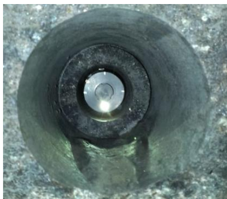
Рисунок 2 – Трехкомпонентный датчик в скважине (1-9 - измерительные направления): а – измерительная скважина; б – кольцевая разгрузочная щель
