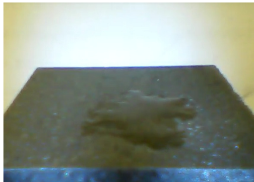
Рисунок 3.13 — Капля раствора, содержащего 1 % глидола, после нанесения на поверхность графита
