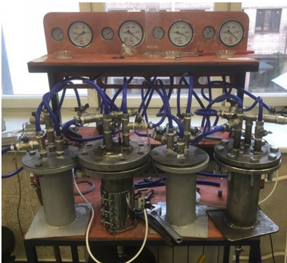
Рисунок 2.17 — Стенд для определения оптимальных условий пропитки (1 и 3 слева автоклавы упрощенной конструкции, 2 и 4 — доработанные, при этом 2 снабжен нагревательным устройством)
