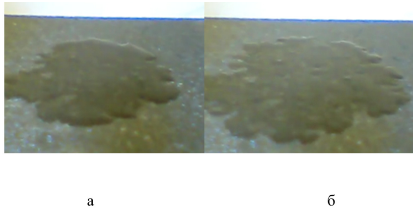
Рисунок 3.20 — Капля раствора, содержащего 1 % Triton после нанесения на поверхность графита. а — в начале опыта; б — через 20 секунд
