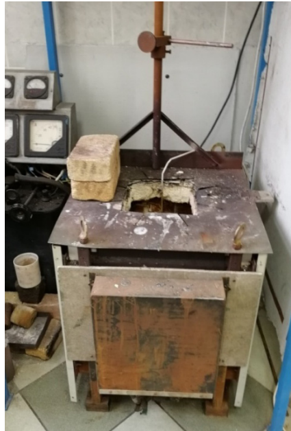
Рисунок 2.21 — Фото печи для сушки образцов электродного графита
