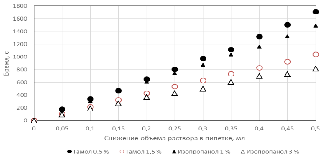
Рисунок 3.23 — Результаты опытов по определению скорости впитывания пропиточных растворов с различными концентрациями
