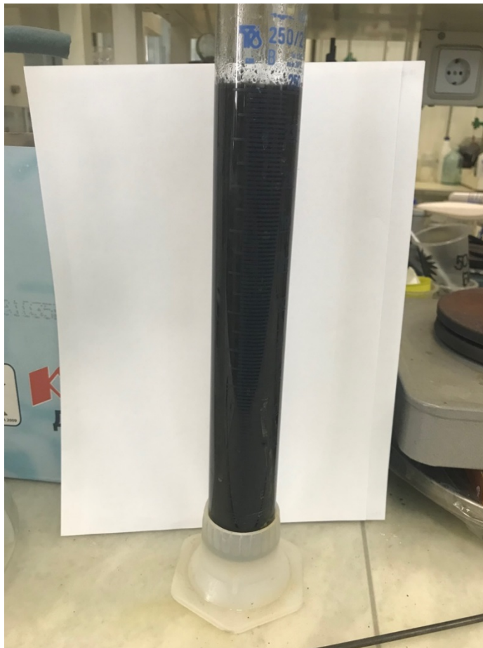
Рисунок 3.46 — Базовый тест на сгущение без применения флокулянтов и коагулянтов
