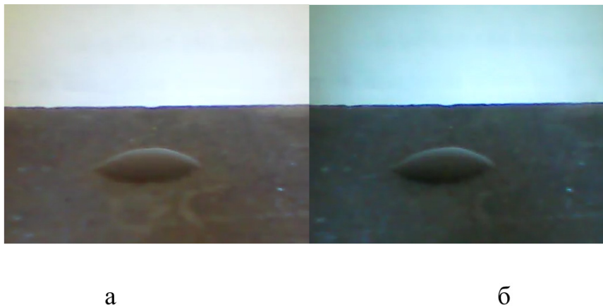
Рисунок 3.17 — Капля раствора, содержащего 1 % Тамол после нанесения на поверхность графита. а — в начале опыта; б — в конце
