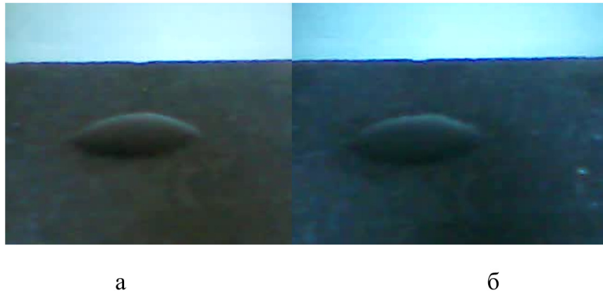
Рисунок 3.16 — Капля раствора, содержащего 5 % Тамол после нанесения на поверхность графита. а — в начале опыта; б — в конце
