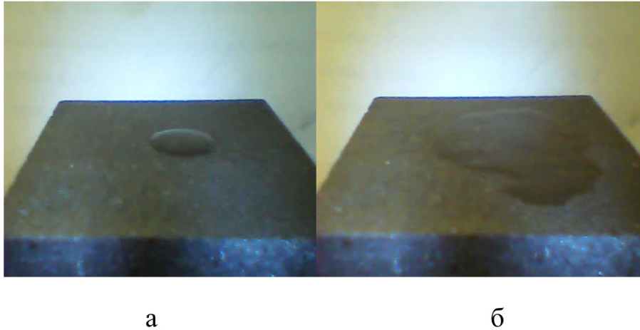
Рисунок 3.9 — Капля раствора, содержащего 5 % изопропилового спирта, после нанесения на поверхность графита. а — начало, б — через 60 секунд
