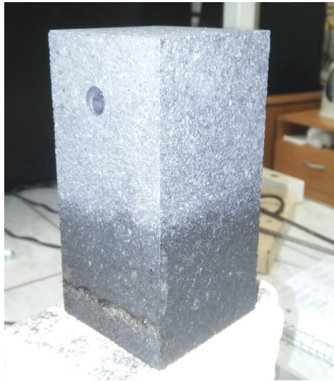
Рисунок 2.9 — Образец графита, пропитанный наполовину (П1Б)
