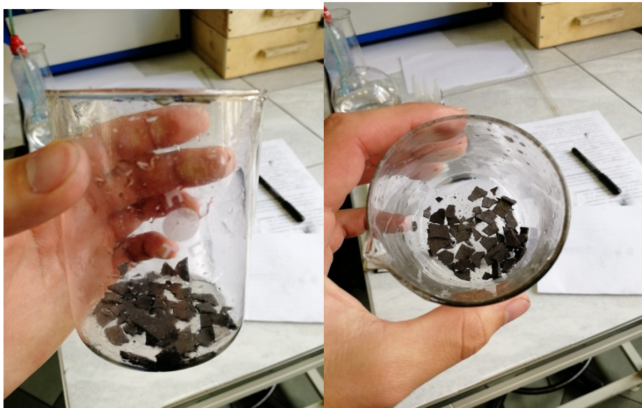
Рисунок 2.12 — Подготовка пластины к выщелачиванию
