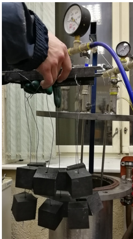
Рисунок 3.25 — Загрузка образцов 50*50*50мм на пропитку
