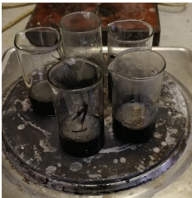
Рисунок 2.14 — Выщелачивание полученного графитового порошка
