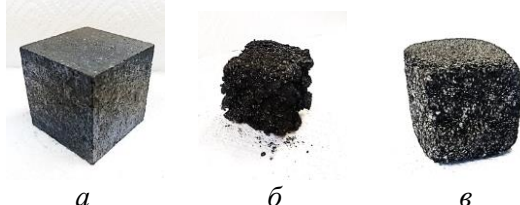
Рисунок 4 – Образец графита: а – до окисления, после окисления при б – 700 °С, в – 1100 °С
