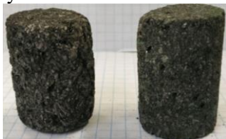
Рисунок 8 – Образцы электродного графита марки УНР после окисления при температуре 1100 °С, слева – непокрытый образец, справа – покрытый, состав покрытия 30 мас.% Cr 2 O 3 , остальное - пек
