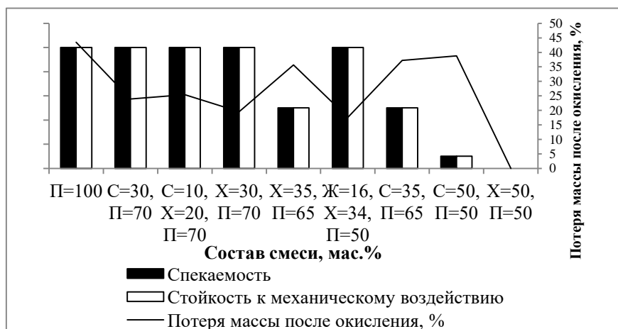
Рисунок 6 – Оценка спексаемости смесей, стойкости к механическому воздействию и окислению, где П – пек, С – SiO 2 , X - Cr 2 O 3 , Ж – FeO 2
