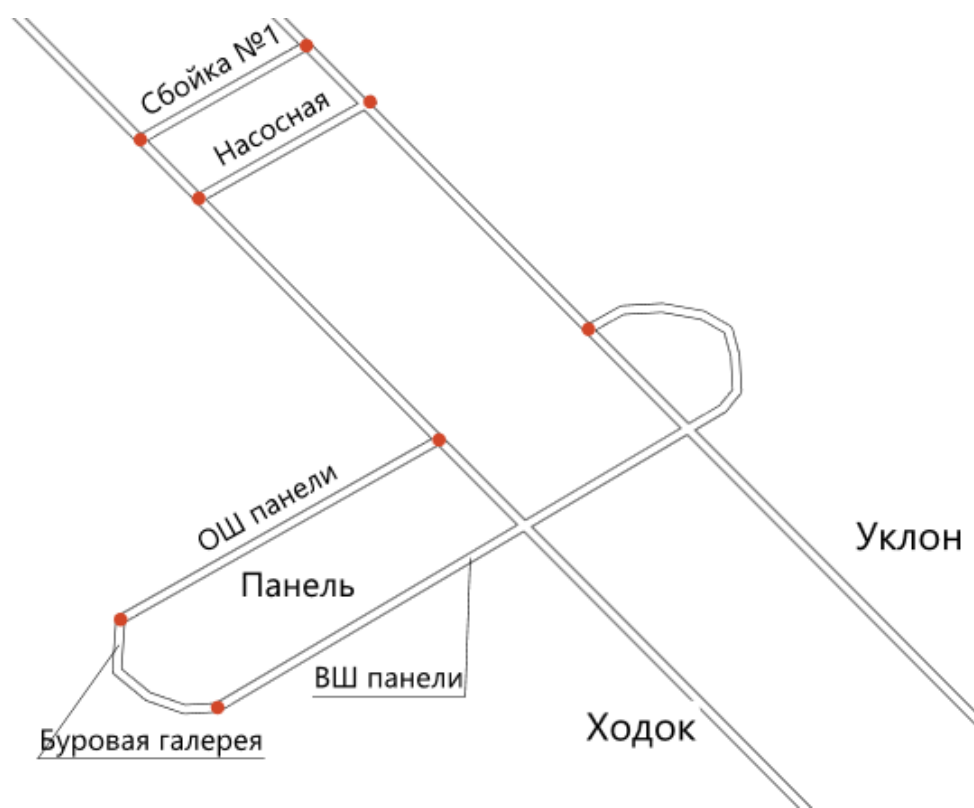
Рисунок 3.5 — Схема расположения горных выработок уклонного блока
