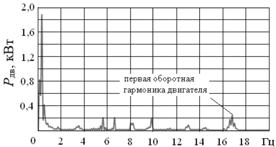
Рисунок 3.8 – Спектр ваттметрограммы УШСН с дефектом электродвигателя СК
