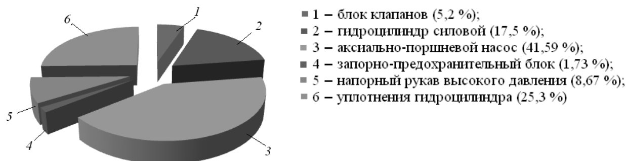
Рисунок 1.27 – Распределение отказов по узлам гидравлической части ЭГП УШСН
