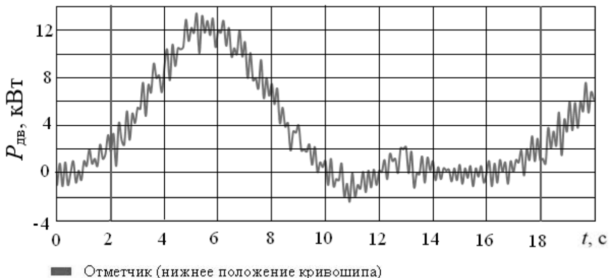
Рисунок 3.6 – Ваттметрограмма УШСН с дефектом нагнетательного клапана насоса
