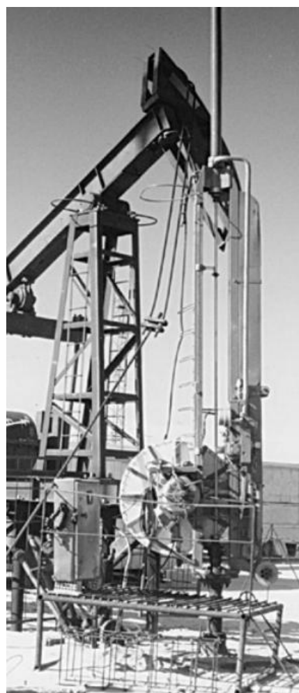
Рисунок 1.17 – Принципиальная схема (а) и общий вид (б) электрогидравлического привода СКГИ-60 с инерционным уравниванием гидропередачи вращающимся маховиком: 1 – силовой гидроцилиндр; 2 – рама; 3 – приводной электродвигатель; 4 – система реверсирования; 5 – насосная станция; 6 – маховик; 7 – станция управления
