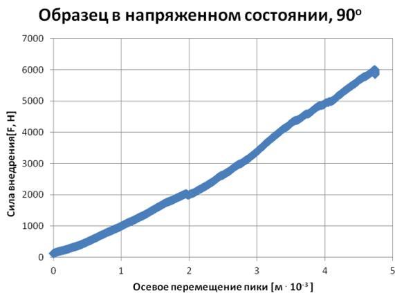
Рисунок 10 – Зависимость изменения силы внедрения и деформирования образцов в напряженном состоянии
