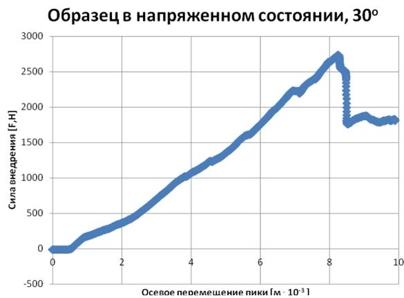
Рисунок 9 – Зависимость изменения силы внедрения и деформирования образцов в напряженном состоянии
