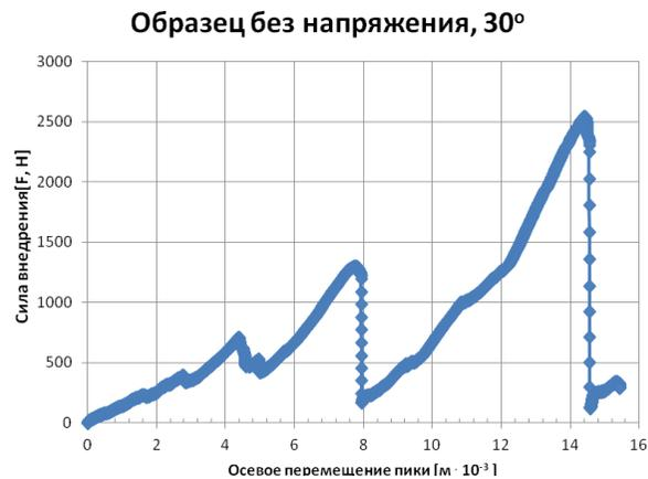
Рисунок 11 – Зависимость изменения силы внедрения и деформирования образцов
