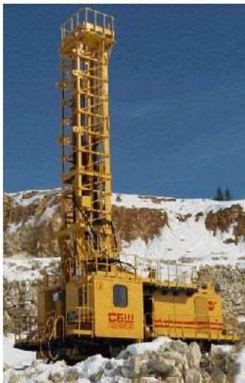
Рисунок 1.3 - Машина буровая шарошечная СБШ-250 МНА-32 Диаметр бурения 190 – 250 мм, глубина бурения 32000 – 55000 мм, масса 80000 – 90000 кг
