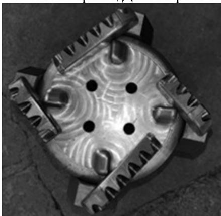
Рисунок 3 – Опытный образец ДБРЛ в положении центриатора
