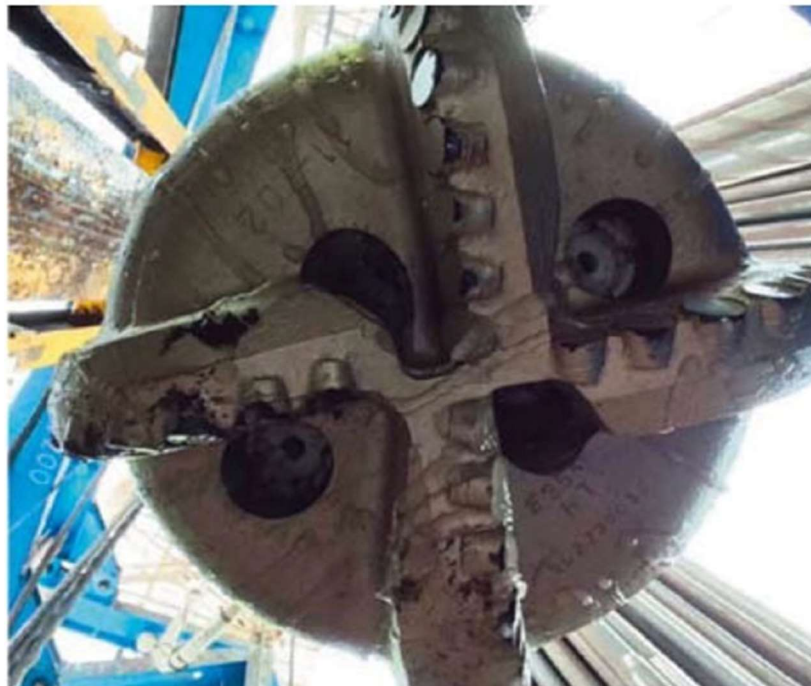
Рисунок 2.31 – Долото из разбуриваемого сплава Direct XCD производства Smith Bits, группы Шлюмберже [106]
