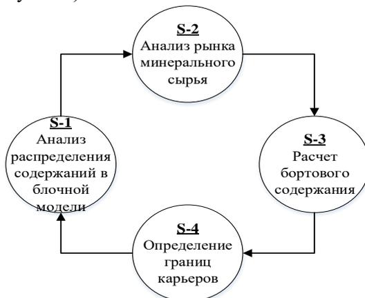
Рисунок 1 – Схема реализации метода формирования рабочей зоны глубоких рудных карьеров
