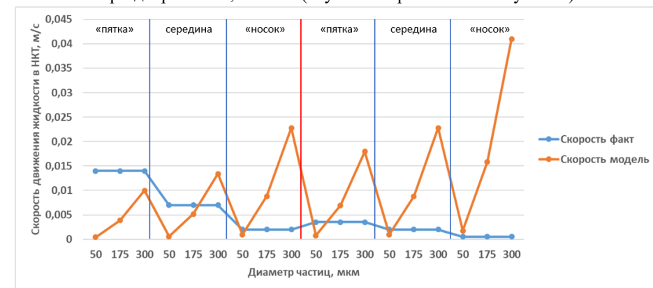
Рисунок 9 – Результаты расчета по модели Ибарра (Ibarra). Левая часть (до красной черты) – работа скважины при депрессии 1,3 МПа, правая часть – работа скважины при депрессии 0,33 МПа (случай с образованием эмульсий)
