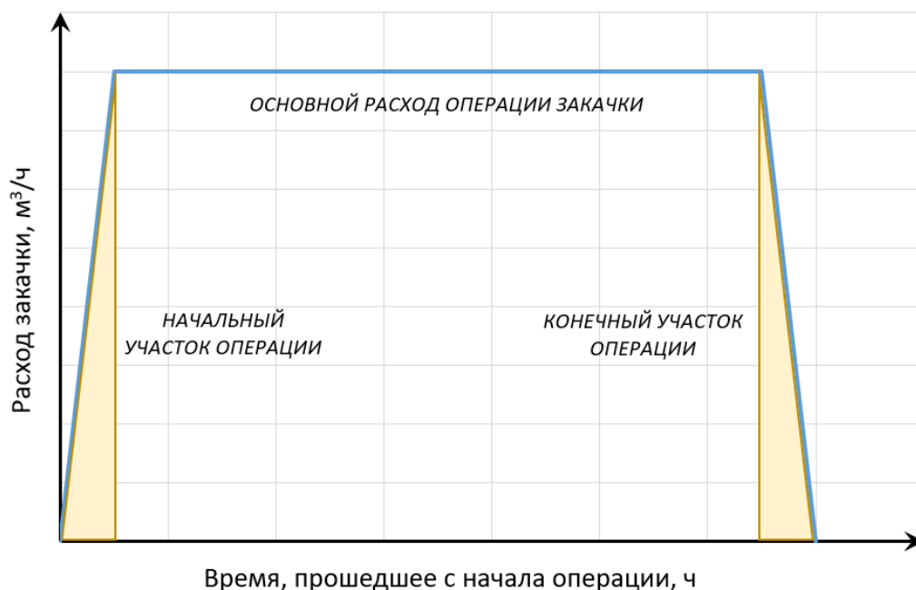
Рисунок 2.2 – Характерный вид зависимости расхода закачки от времени при выполнении операций заполнения резервуаров и транспортных емкостей (составлено автором)
