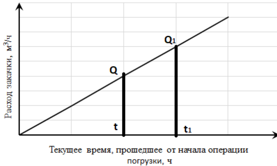
Рисунок 2.4 – Примитивная схема определения объема закачки на линейном участке роста расхода закачки (составлено автором)
