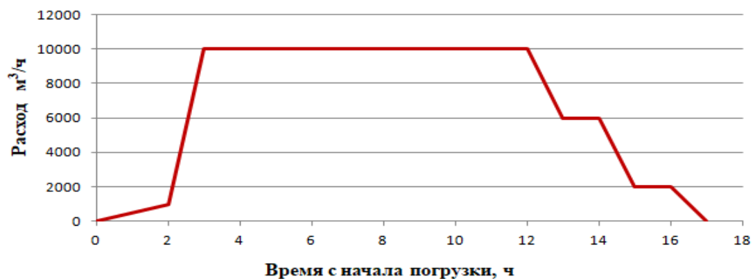
Рисунок 4.5 – Динамика изменения объемного расхода продукта в процессе загрузки танкера во времени (составлено автором)
