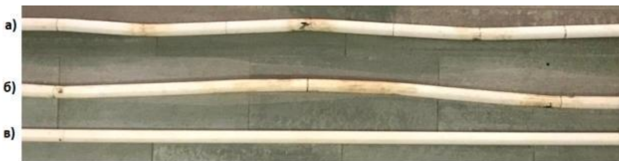
Рисунок 2.3.6 – Бурильные трубы: а) 3 полуволены L_3 = 0,6 м; б) 1 полуволенна L_1 = 1,8 м; в) прямая труба без полуволен L_0 .
