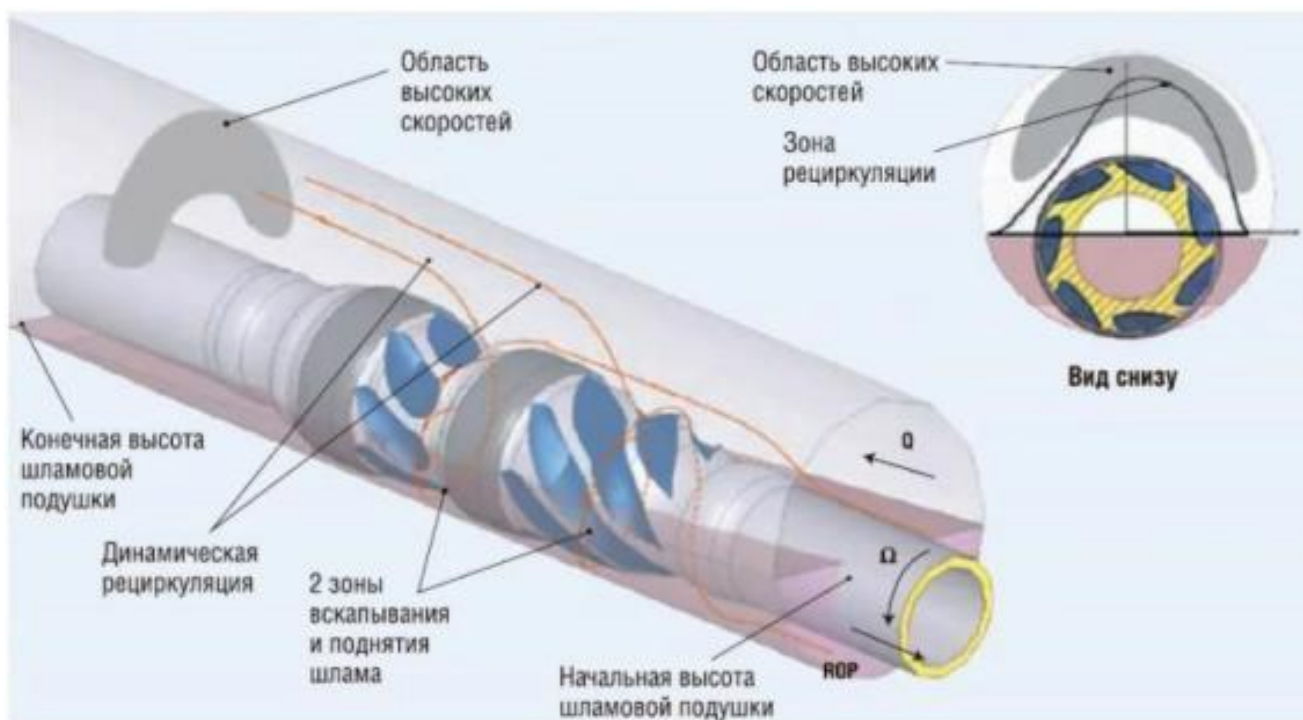
Рисунок 1.6.2 – Принцип работы усовершенствованной бурильной трубы «Hydroclean» [13]
