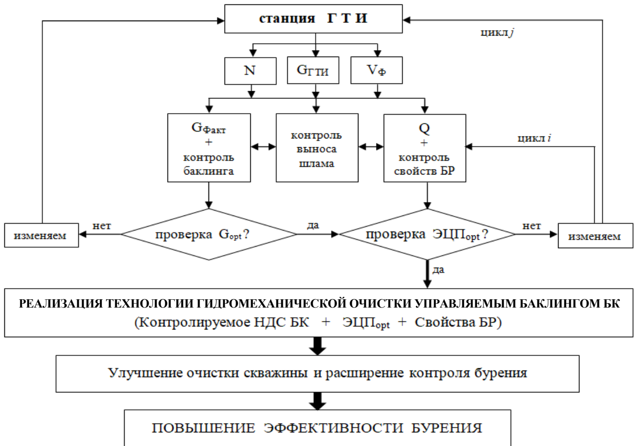
Рисунок 4.3.1 – Алгоритм оперативного контроля и управления параметрами бурения НН скважин при реализации технологии гидромеханической очистки от шлама
