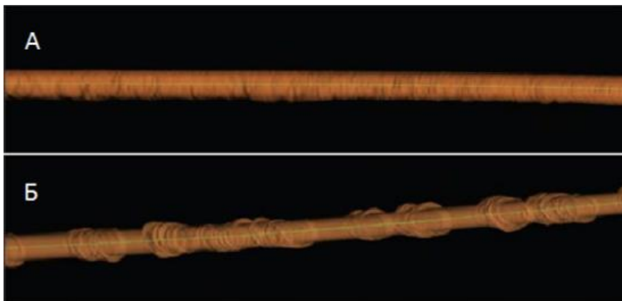
Рисунок 1.1.3 – Сравнение участков скважины, пробуренных РУС (а) и ВЗД (б) [81]
