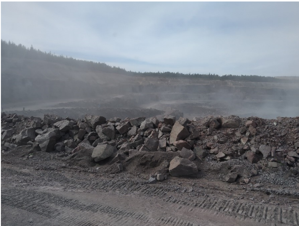
Рисунок 1.12 – Пылевая обстановка после проведения массового взрыва в период положительных температур
