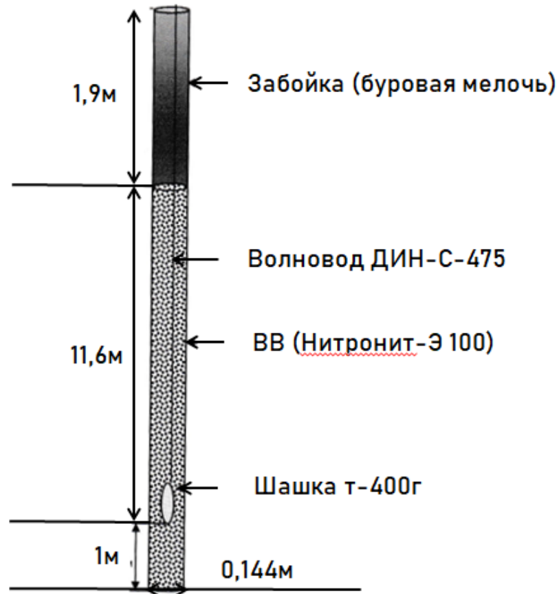
Рисунок 2.1 – Конструкция скважинного заряда на карьере «Гавриловский»
