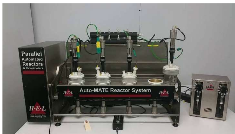
Рисунок 2.1 – Реакторная установка с автоматизированной подачей реагентов и термостатированием.
