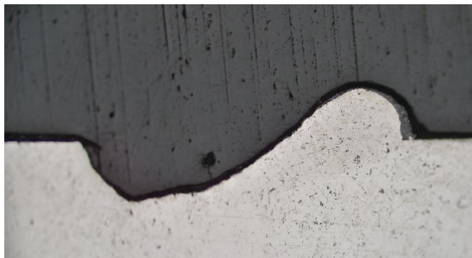
Рисунок 2 – Вид рельефа в поперечном сечении, сформированного методом перераспределения расплава при лазерной обработке (увеличение \times 50 )
