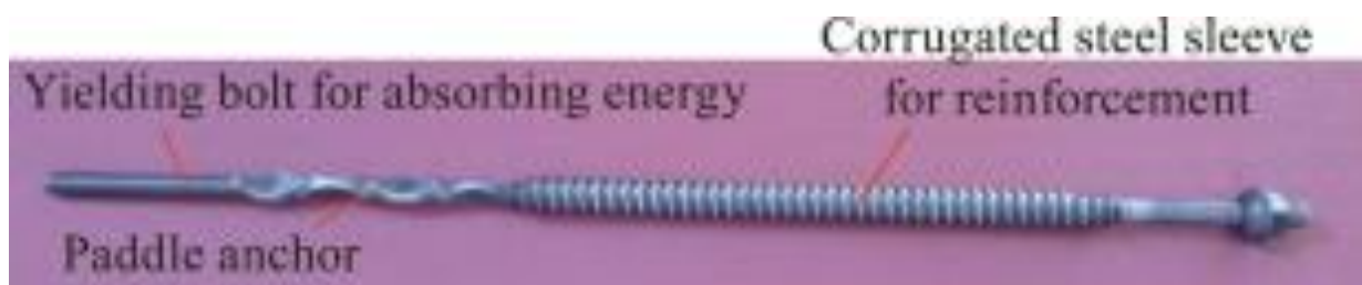
Рисунок 1.2 – Динамический анкер «Versa-superbolt» [70]
