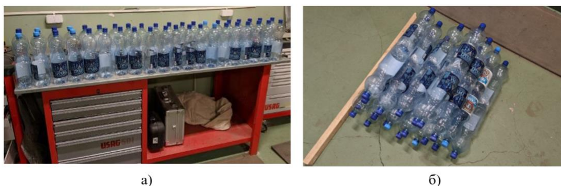
Рисунок 4.9 – Основание для макета заряда: а) пластиковые бутылки объемом 1,5 л, общий вид; б) попарное соединение бутылок «дном ко дну»
