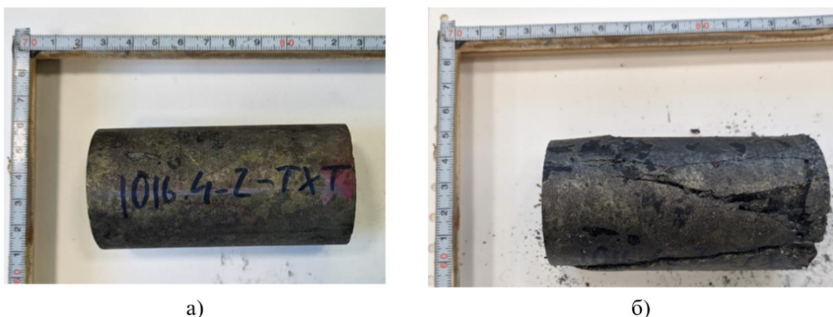
Рисунок 3.10 – Состояние образца при испытании на объемное сжатие:
