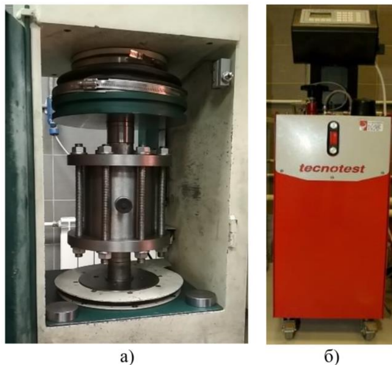
Рисунок 2.4 – Испытания на трехосное сжатие: а) камера объемного сжатия на испытательном прессе TO 317E; б) маслостанция TS 709/B15
