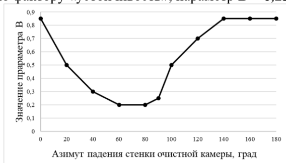
Рисунок 6 - График зависимости величины параметра В (методика Мэтьюза-Потвина), учитывающего ориентацию систем трещин в залежах вкрапленных руд, от ориентации стенок очистной камеры
