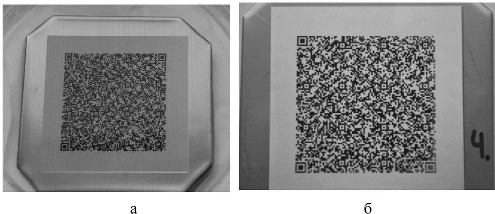
Рисунок 5.20– Образец до (а) и после (б) промывки, при выдержке в «Химитек универсал-ПД»
