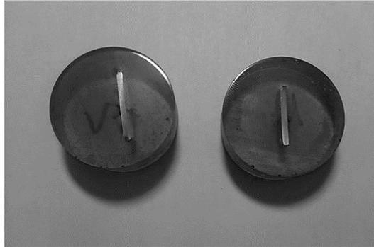
Рисунок 2.7 – Готовые металлографические шлифы
