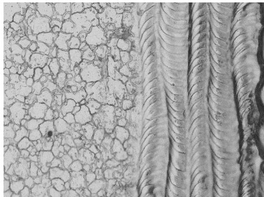
Рисунок 5.24 – Область контакта подложки и чистой поверхности ( $\times 20$ )
