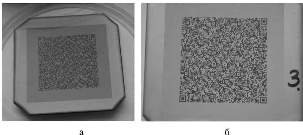
Рисунок 5.19 – Образец до (а) и после (б) промывки, при выдержке в «Туалетный утенок»
