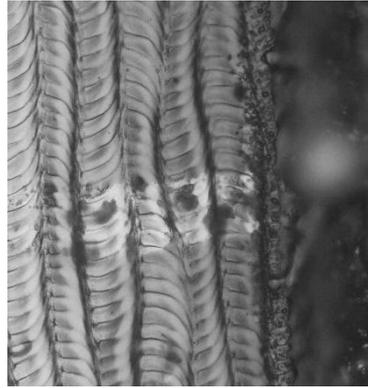
Рисунок 4.10 – Микроструктура поверхности со следом профилометра,  $\times 50$
