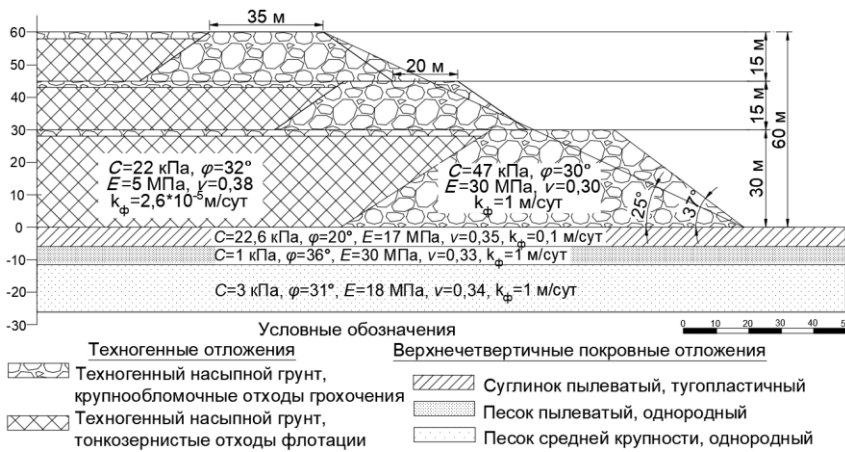
Рисунок 6 – Расчётная схема отвала для заключительного этапа отвалообразования
