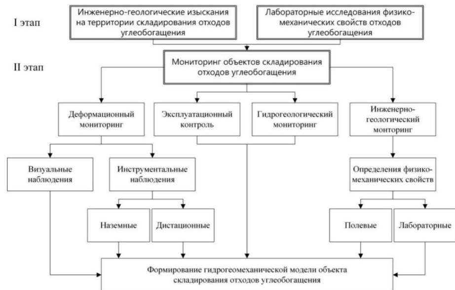
Рисунок 5 – Схема производства работ в рамках мониторинга состояния отвалов для складирования отходов углебогачения
