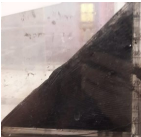
Рисунок 3.7 – Испытание отходов флотации в приборе для определения угла естественного откоса
