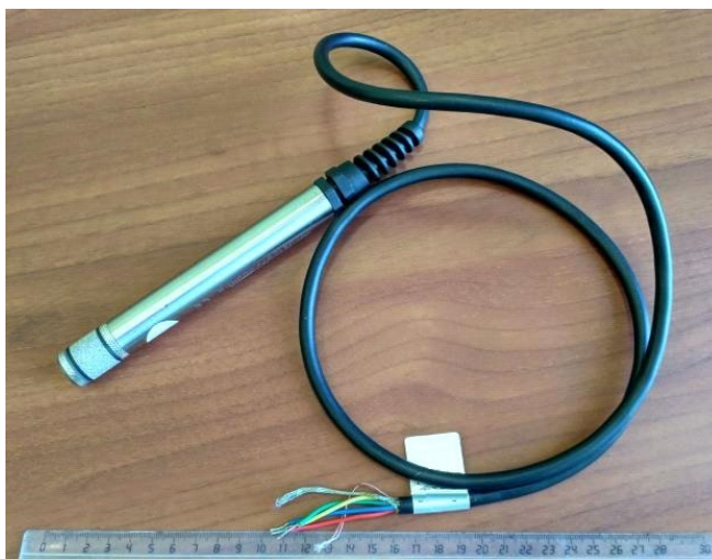
Рисунок 4.13 – Датчик со встроенным термистором Soil Instruments
