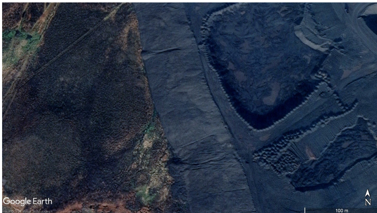
Рисунок 4.11 – Локальные деформации первого яруса отвала ЦОФ «Печорская» в виде конусов выноса
