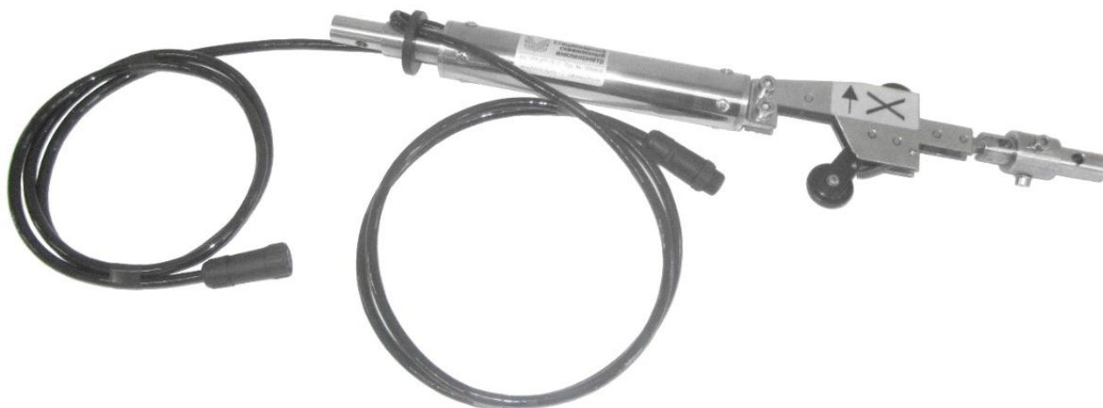
Рисунок 4.8 - Внешний вид стационарного скважинного инклинометра
