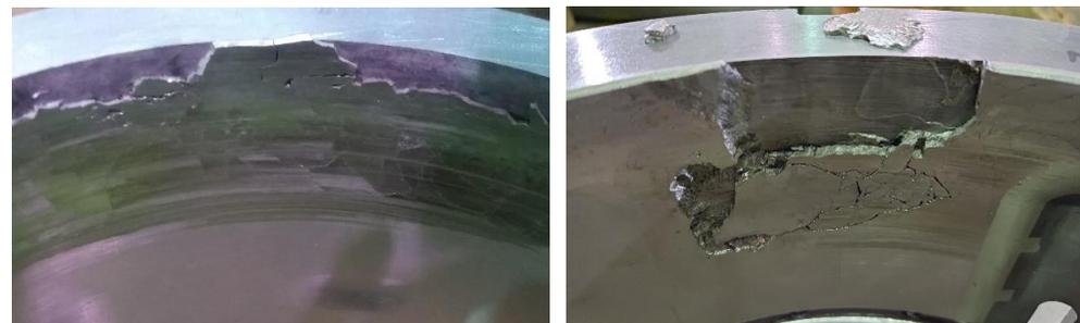
Рисунок 2 – Разрушение баббитового слоя вкладышей подшипников скольжения с цапфами группы Ц<sub>4.авр</sub> в течение трех часов работы при температуре в узле свыше 120-130 °С и удельной нагрузке на подшипники 3,3 МПа
