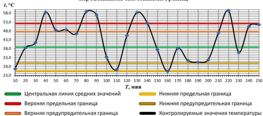
Рисунок 8 – Мониторинг величины нагрева и интенсивности роста температуры в подшипнике с цапфой группы Ц<sub>3.пов</sub> при корректирующих мероприятиях, направленных на работу системы смазки, в режиме реального времени с нанесением полученных данных на расчетную контрольную карту Шухарта с фиксированными значениями границ
