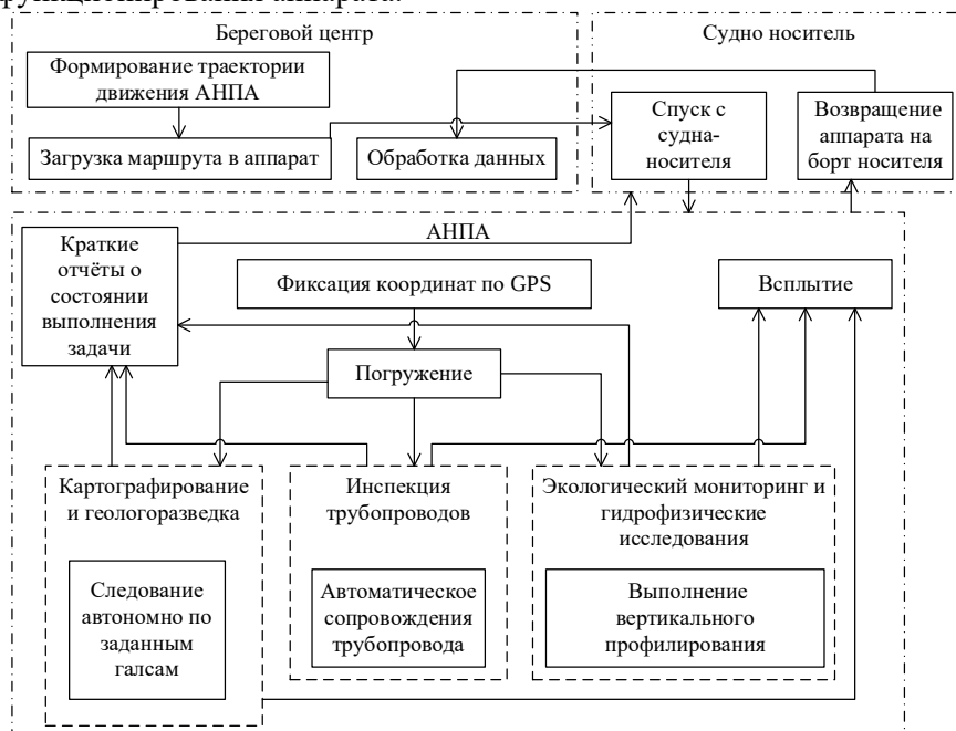
Рисунок 2 – Возможные сценарии функционирования АНПА
