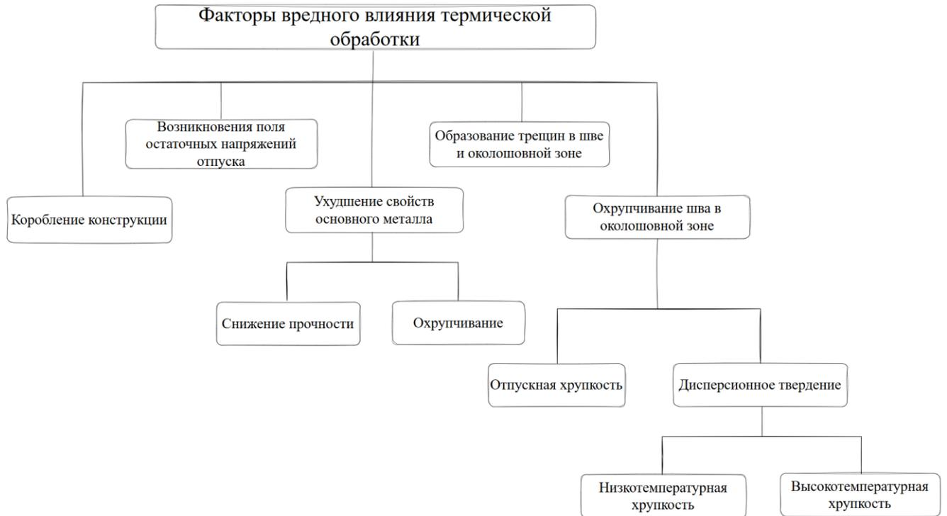
Рисунок 1.7 – Возможные отрицательные последствия проведения термической обработки [53]
