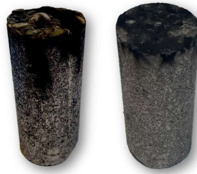
Рисунок 13 - Внешний вид образцов сформованных из структурированной после экструзии электродной массы (слева) и из стандартного УГМ (справа) после эксперимента имитационной руднотермической плавки кремния
