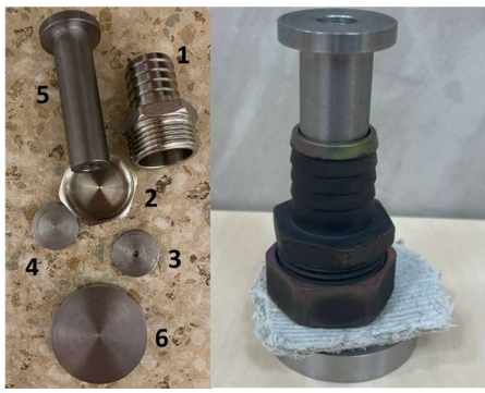
Рисунок 8 - Прототип лабораторного экструдера: 1 – загрузочная камера; 2 – неподвижное дно; 3 – подвижное дно (экструзионная матрица); 4 – сменное подвижное дно (пресс); 5 – полый шток (исполнительное устройство); 6 – опорная площадка
