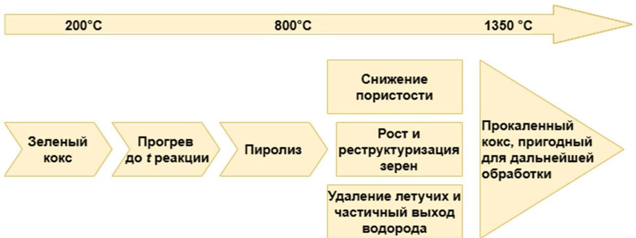
Рисунок 2.1 - Блок-схема, описывающая процесс высокотемпературной обработки зеленого кокса
