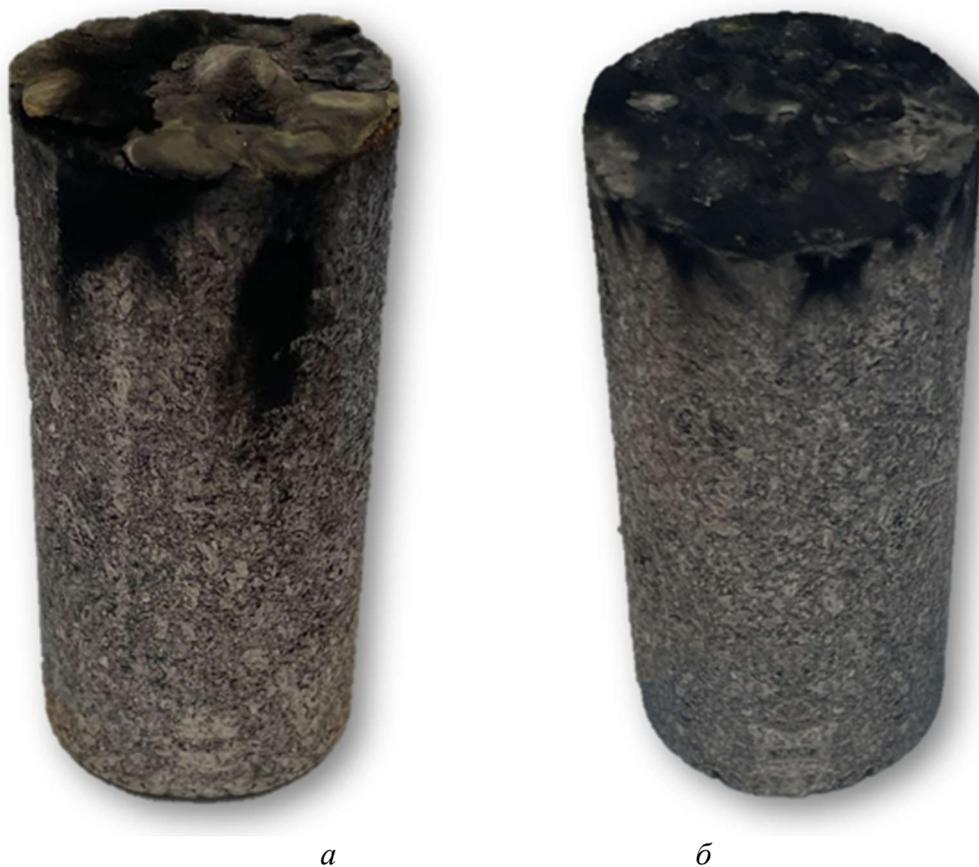
Рисунок 4.15 - Внешний вид образцов сформованных из стандартного УГМ (а) и из структурированной после экструзии электродной массы (б) после эксперимента иммитационной руднотермической плавки кремния
