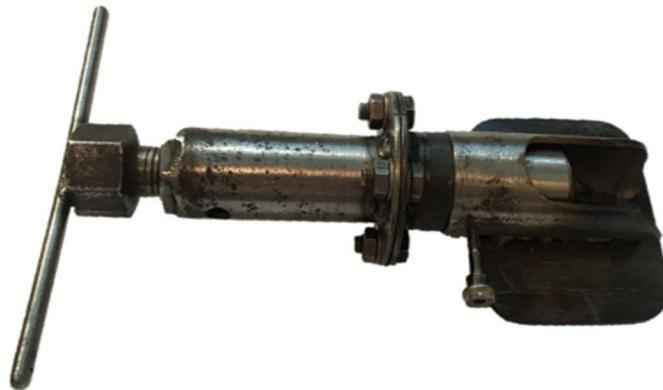
Рисунок 4.2 – Устройство для подготовки таблеток из углеродной массы
