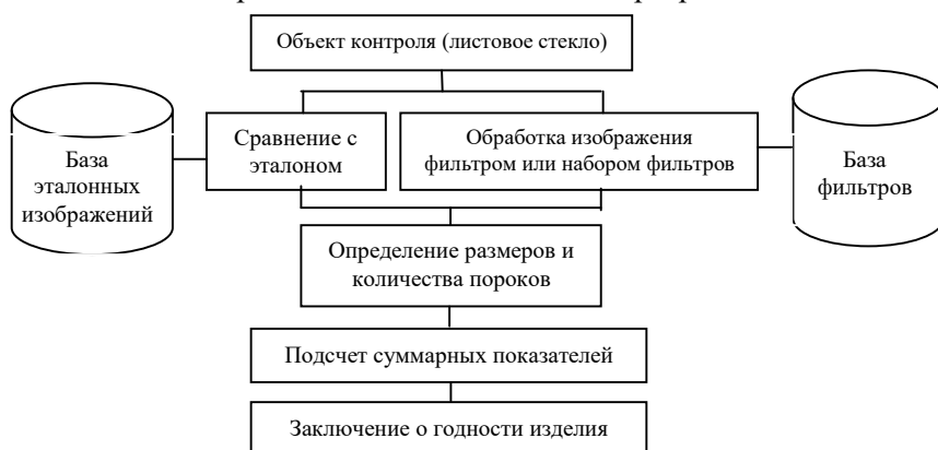
Рисунок 3 – Обобщенный алгоритм оценки качества светопрозрачных изделий
