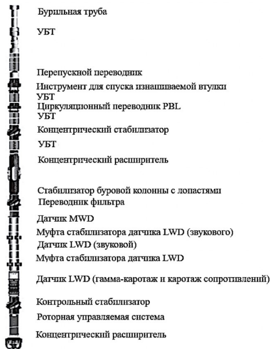
Рисунок 1.11 – Пример КНБК с РУС и датчиками MWD и LWD [53]
