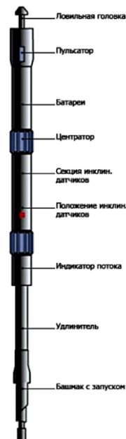
Рисунок 1.8 – Система телеметрии с гидравлическим каналом связи MWD System MWDQ 55-1 Becfield
