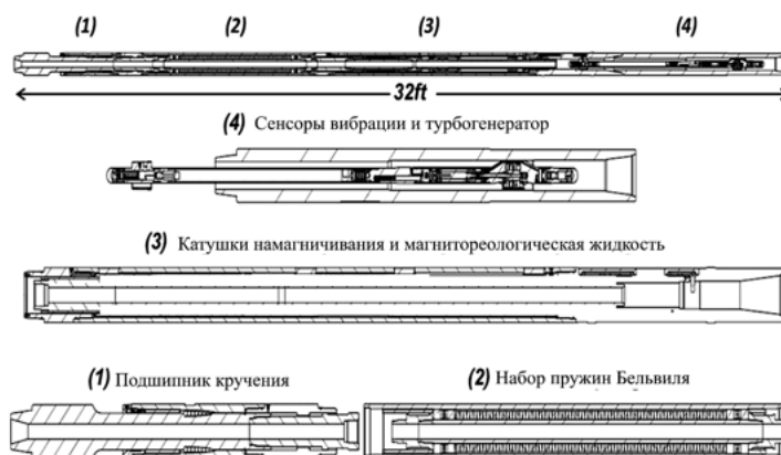
Рисунок 1.12 – Адаптивный амортизатор Хатчинсона: 1 – подшипник кручения; 2 – набор пружин Бельвиля; 3 – магнито реологическая жидкость и намагничивающие катушки; 4 – электроника, содержащая датчики вибрации, логику управления демпфером, память и турбогенератор
