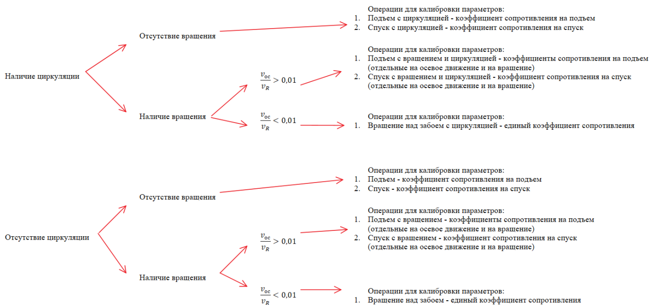
Рисунок 4.5 – Однотипность технологических операций и калибровка коэффициента сопротивления движению (составлено автором)
