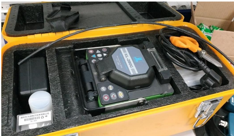
Рисунок 2.3 – Автоматический сварочный аппарат (фото автора)
