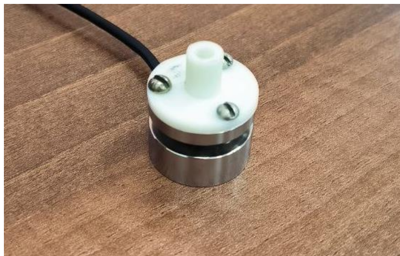
Рисунок 2.9 – Фиксатор бурильной колонны, распечатанный на 3Д принтере для диаметра стержня, используемого в экспериментах. Фиксатор установлен на тензодатчике колонного типа (фото автора)
