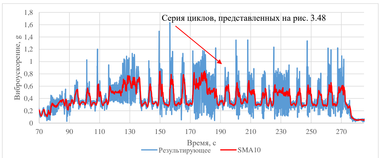
Рисунок 3.49 – Виброграмма проведенного эксперимента. Результирующее виброускорение с учетом колебаний по Oх и простая скользящая средняя SMA 10 результирующих виброускорений по 10 предыдущим измерениям для фильтрации данных (составлено автором)
