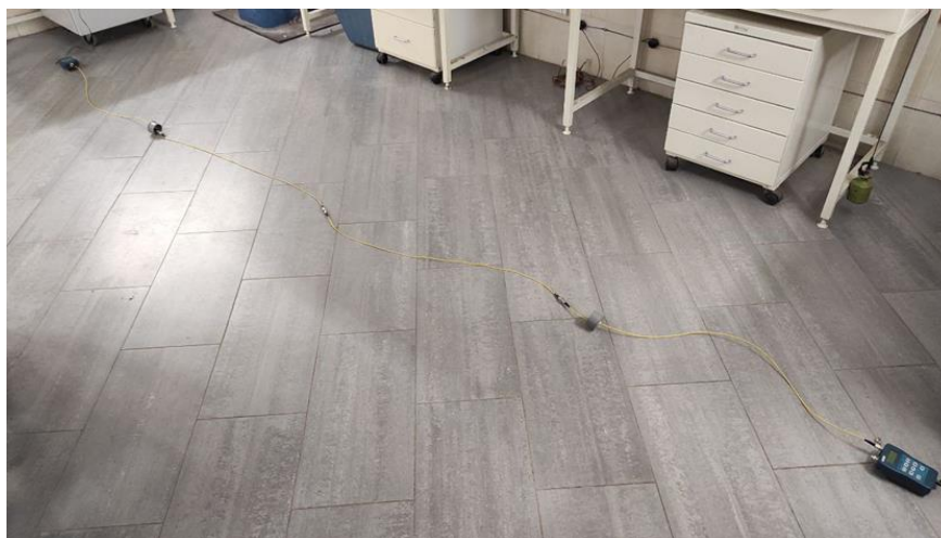
Рисунок 3.1 – Комплект ОВ кабеля. Определение базовых потерь сигнала без циркуляции бурового раствора (фото автора)
