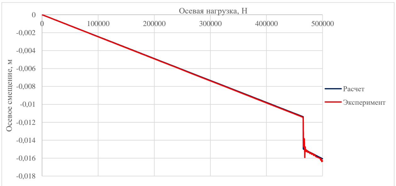
Рисунок 3.45 – Сравнение расчетного и экспериментального значений осевой деформации колонны в эксперименте с вертикальными колебаниями с амплитудой 1g и частотой 5 Гц при отсутствии трения БК о стенки скважины [76]
