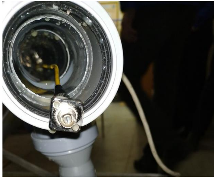
Рисунок 3.2 – Состояние муфты, аттенуатор-розетки, после циркуляции глинистого бурового раствора (фото автора)
