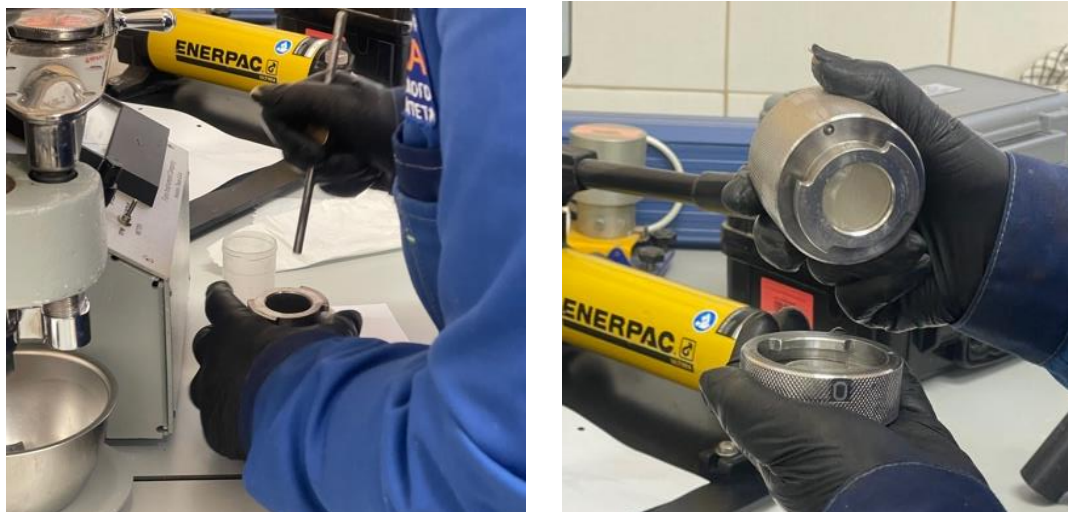
Рисунок 2.8 – Приготовление таблеток диаметром 30 мм и высотой 13 мм (фото автора)
