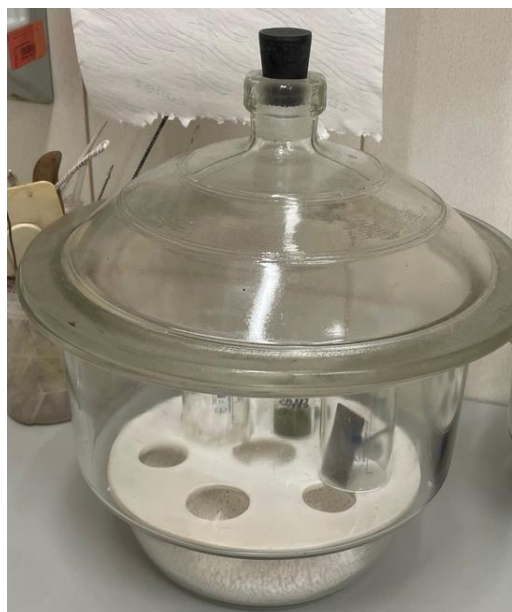
Рисунок 2.11 – Сушка пластинок в эксикаторе (фото автора)
