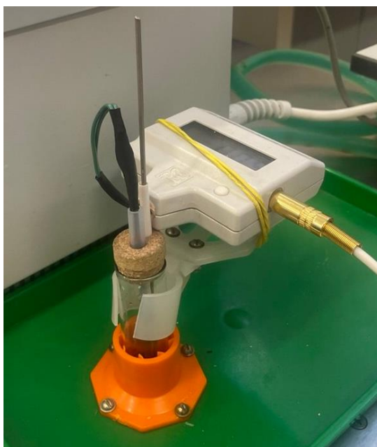
Рисунок 2.12 – Пробирка с термопарой и измерительным преобразователем (фото автора)
