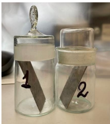
Рисунок 2.10 – Подготовка пластинок к эксперименту на определение коррозионной активности ингибирующего состава (фото автора)
