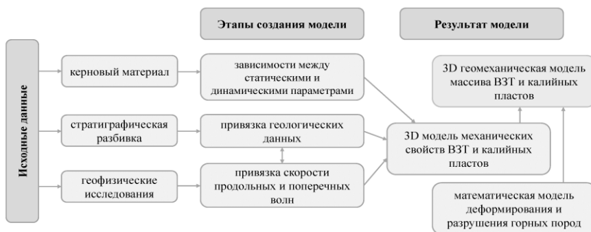
Рисунок 3 – Блок-схема создания геолого-геомеханической модели водозащитной толщи и калийных пластов
