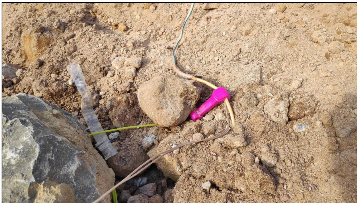
Рисунок 3.7 – Крепление триггерного провода (фото автора)
