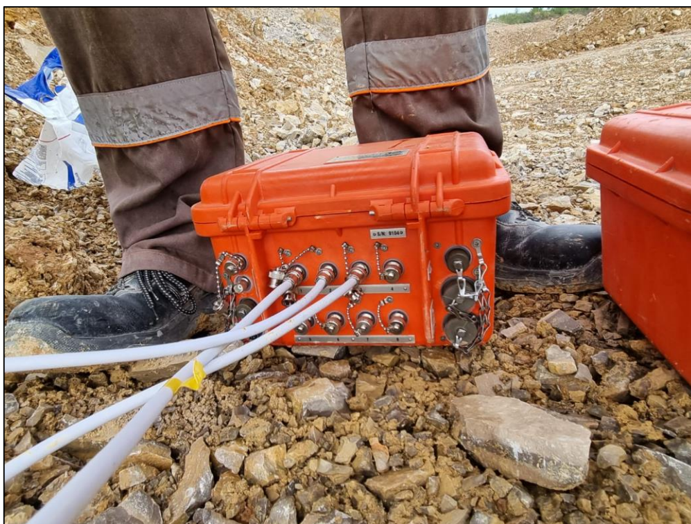
Рисунок 3.18 – Подключение проводов к прибору (фото автора)
