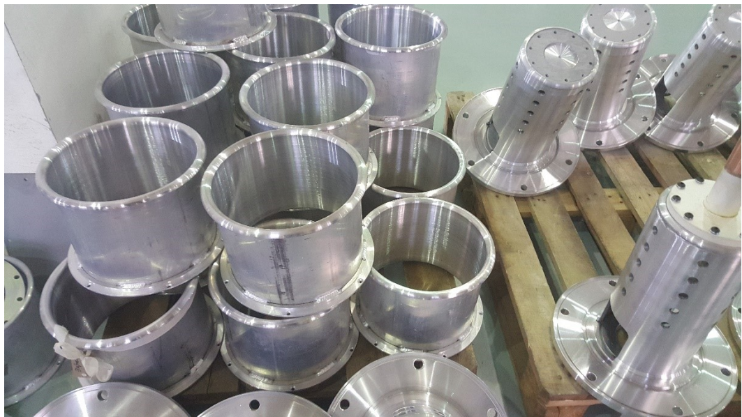
Рисунок 1.4 – Цилиндры элегазового трансформатора, где: а – в сборе; б – размерный ряд цилиндров и труб
