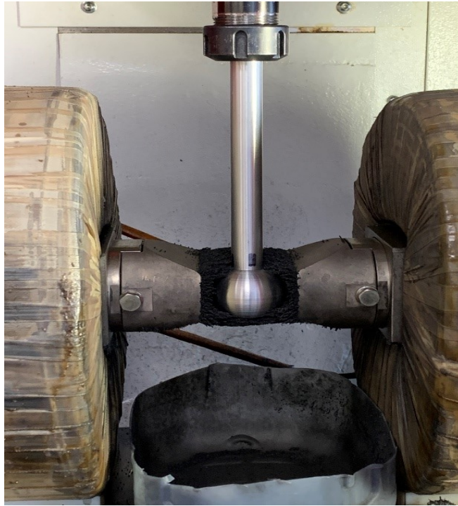
Рисунок 2.4 – Процесс МАО сфероида на установке с плоскими полюсными наконечниками на базе фрезерного станка
