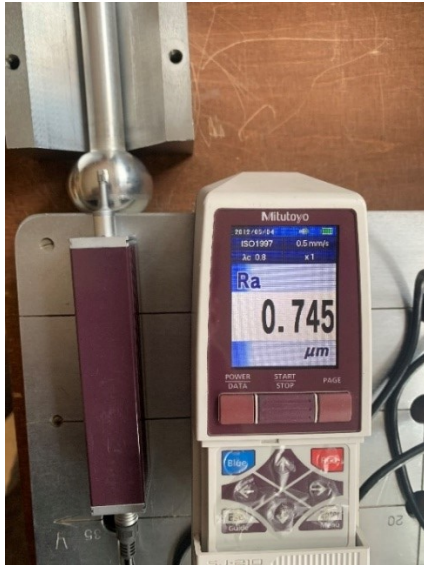
Рисунок 3.3 – Результаты измерения шероховатости сложнопрофильной поверхности в центральной части сфероида
