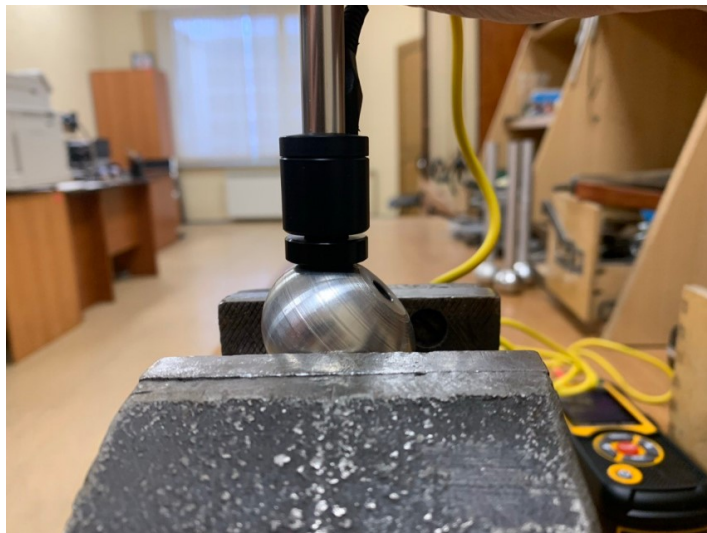
Рисунок 4.6 – Процесс измерения твердости сложнопрофильной поверхности
