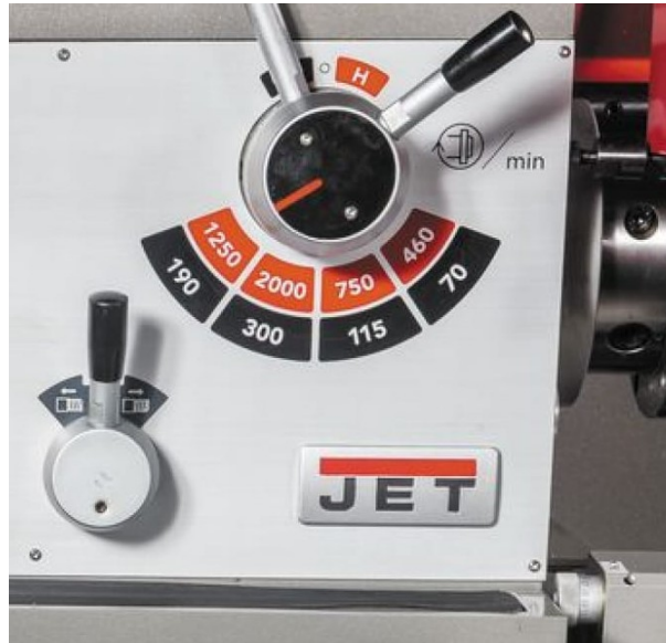
Рисунок 2.27 – Частоты вращения шпинделя токарно-винторезного станка JET GHB 1340A DRO
