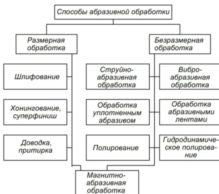
Рисунок 1.11 – Способы абразивной обработки [7]
