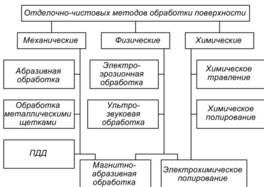
Рисунок 1.10 – Классификация методов окончательной обработки по способу их осуществления [7]
