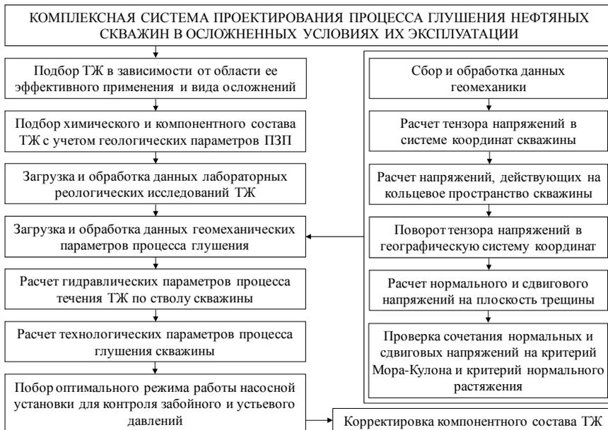
Рисунок 7 – Комплексная система проектирования процесса глушения нефтяных скважин
