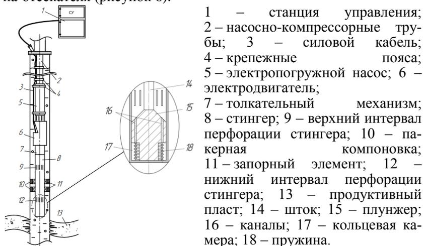
Рисунок б – Принципиальная схема разработанной модели клапана-отсекателя
