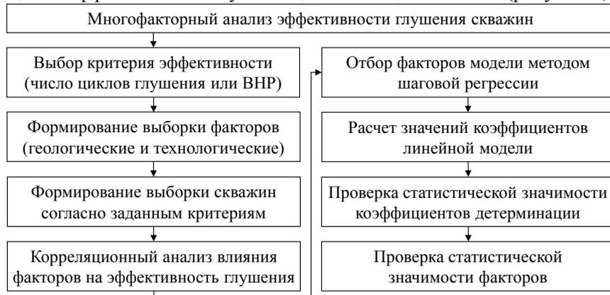
Рисунок 1 – Алгоритм многофакторного анализа эффективности глушения скважин
