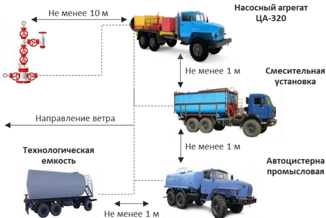
Рисунок 5.4 – Схема расстановки техники при глушении скважины [44, 336, 337]
