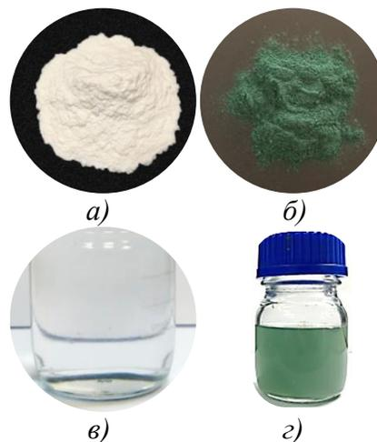
Рисунок 3.48 – Компоненты блокирующего полимерного состава (БПС): *а)* – природный полисахарид (ксантановая камедь); *б)* – сшивающий агент (ацетат хрома); *в)* – регулятор сшивки (2-Меркаптоэтанол); *г)* – внешний вид БПС
