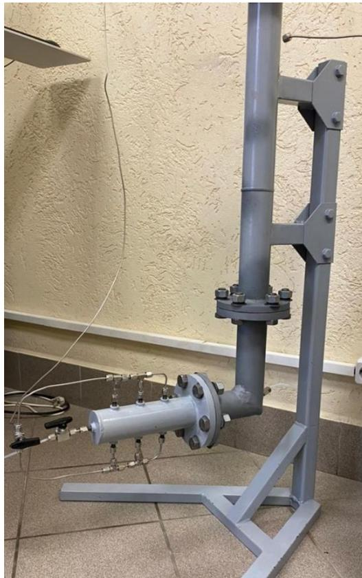
Рисунок 3.31 – Внешний вид стенда по оценке газодерживающих свойств блокирующих составов в условиях горизонтального окончания скважины [44]
