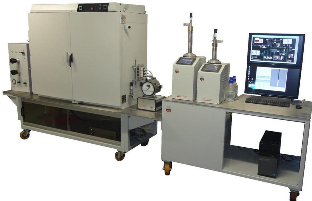
Рисунок 3.19 – Внешний вид фильтрационной установки AutoFlood-700
