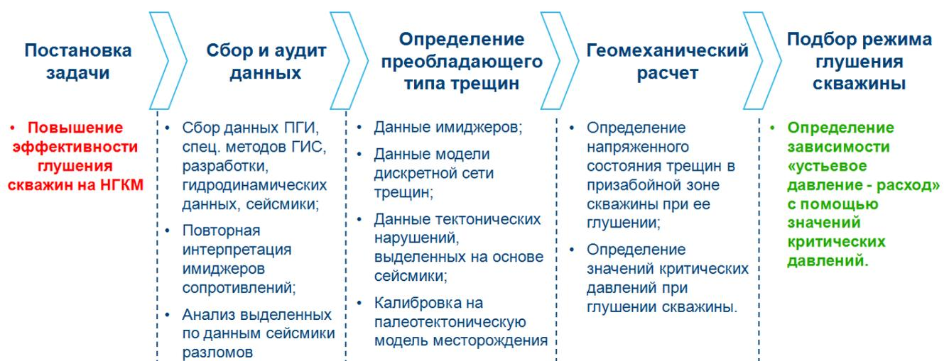
Рисунок 2.36 – Методика геомеханического сопровождения процесса глушения скважин
