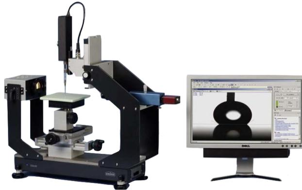
Рисунок 3.4 – Прибор EASY DROP DSA 15E для измерения межфазного натяжения на границе раздела фаз
