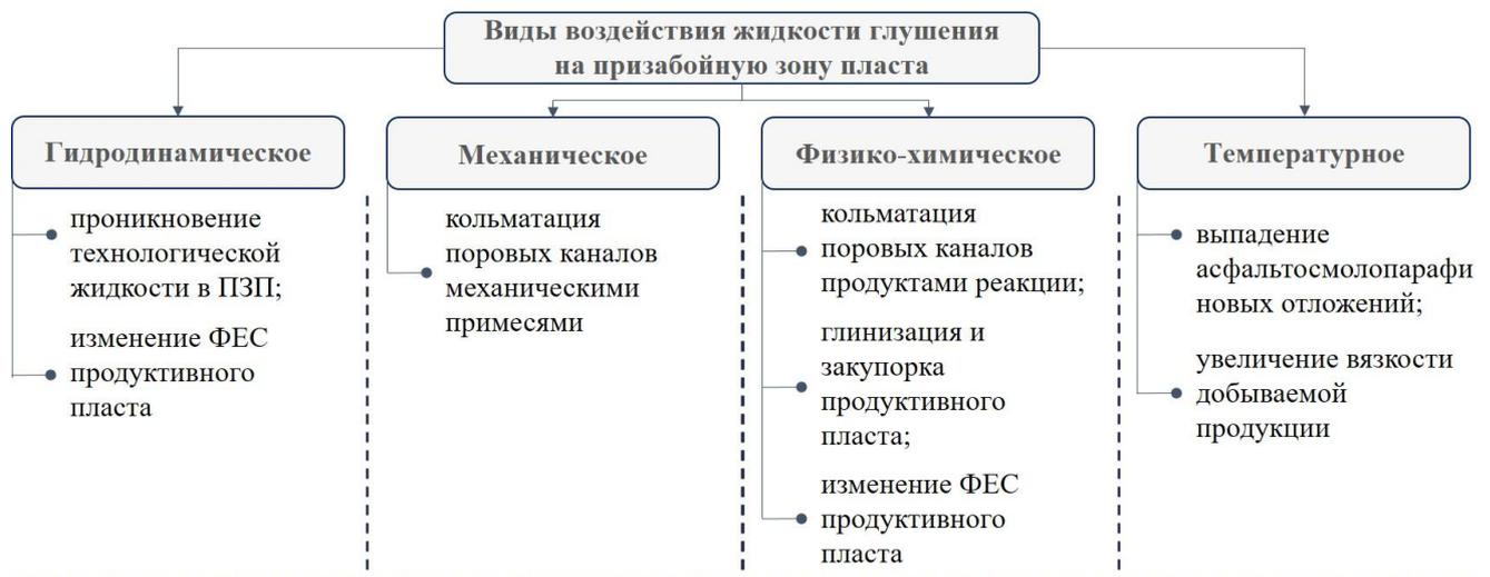
Рисунок 1.1 – Классификация видов негативного воздействия жидкостей глушения скважин на призабойную зону пласта [46]
