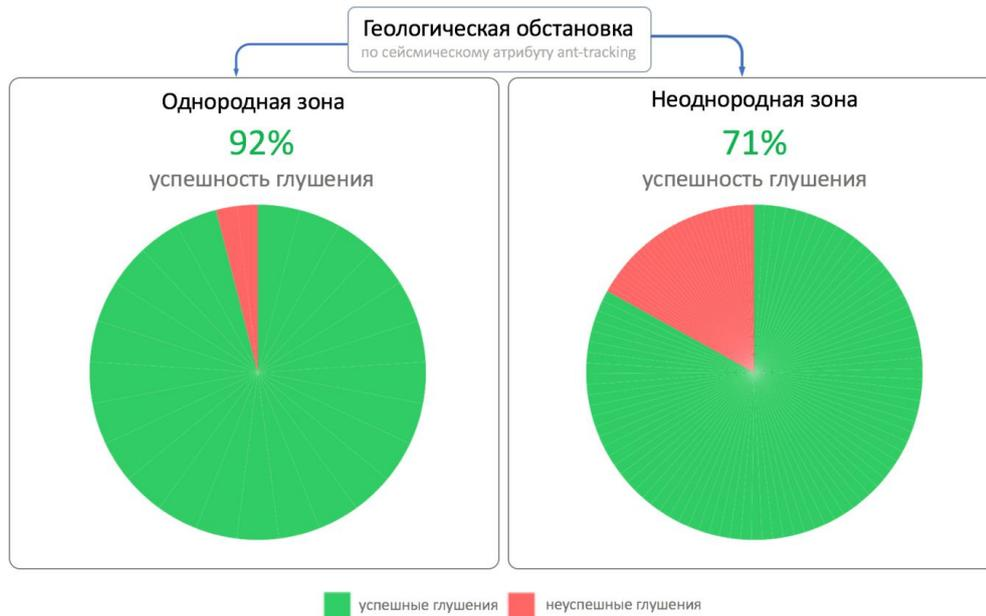
Рисунок 2.23 – Результаты анализа успешности глушений скважин в зависимости от геологической обстановки (сейсмический атрибут «Ant-tracking»)
