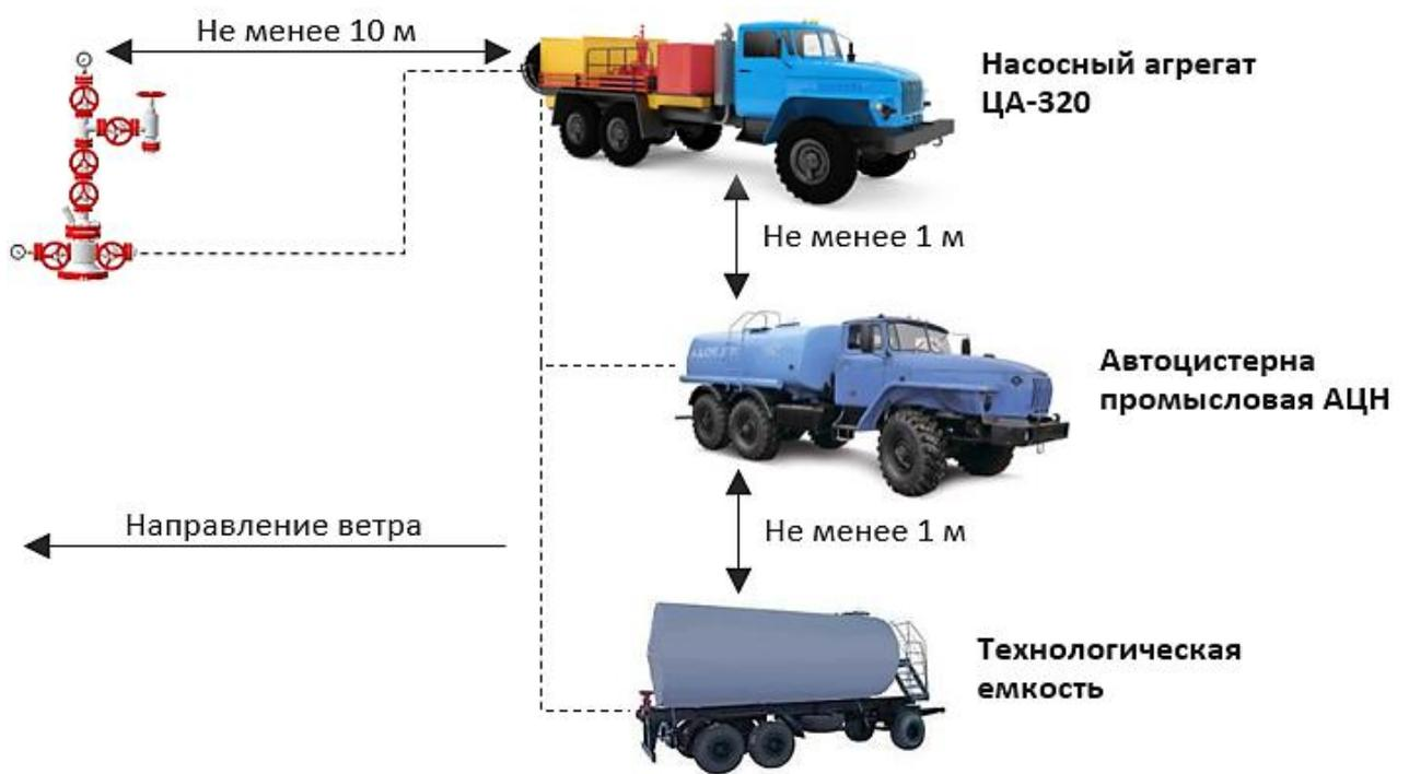
Рисунок 5.2 – Схема расстановки техники при глушении скважины с применением блокирующего состава ОВНЭ
