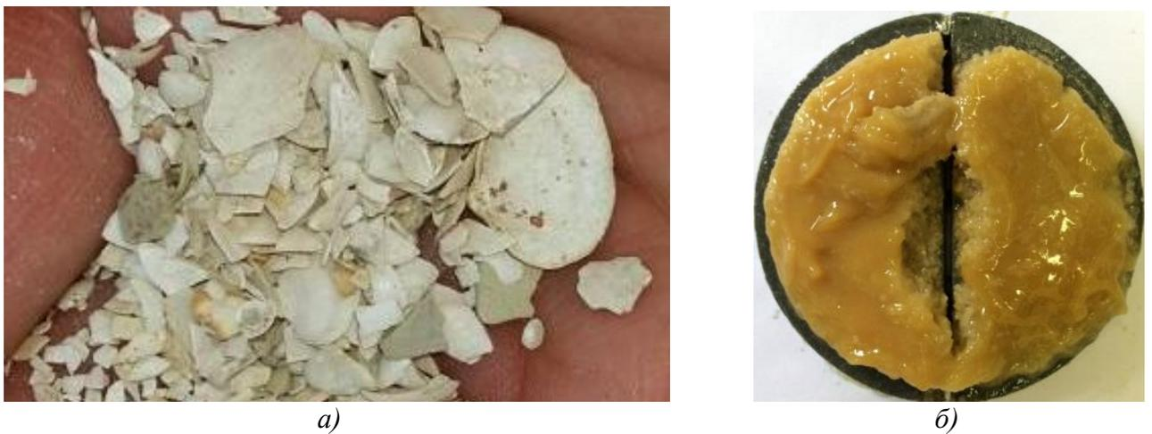
Рисунок 3.59 – Внешний вид ракушечника (а) и блокирующего эмульсионного состава с Галитом над трещиной раскрытостью 0,5 мм после эксперимента на фильтр-прессе (б)
