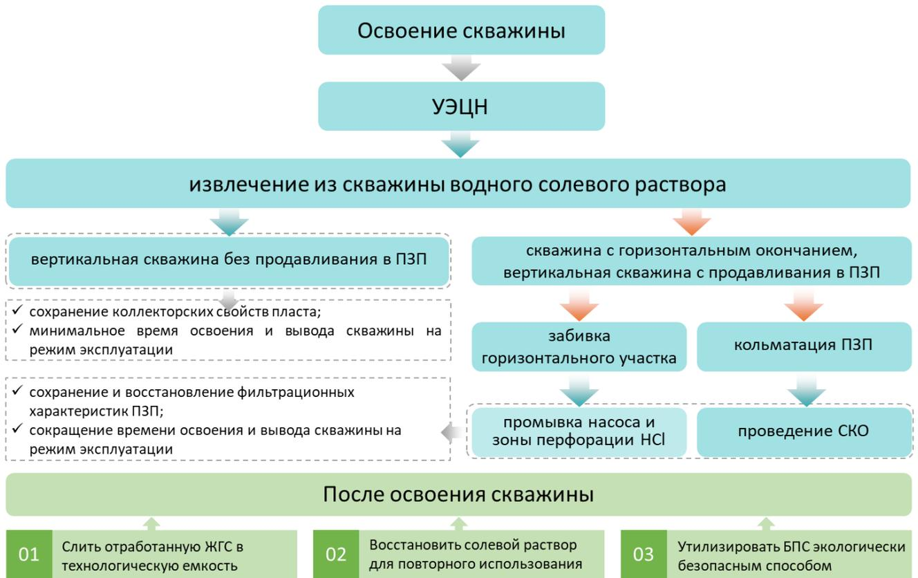
Рисунок 5.6 – Схема освоения вертикальных и горизонтальных скважин после проведения подземного ремонта с (и без) продавливания БПС в ПЗП [44]
