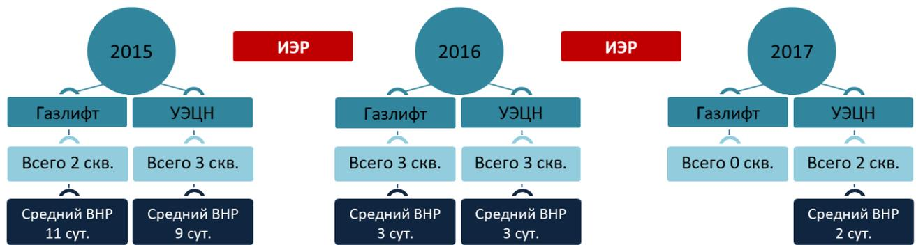
Рисунок 2.4 – Анализ влияния эмульсионного блокирующего состава на ВНР в зависимости от способа эксплуатации скважины
