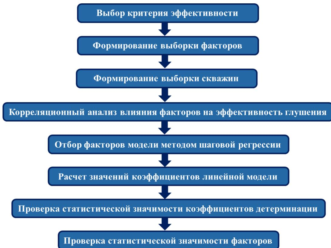
Рисунок 2.2 – Блок-схема алгоритма проведения многофакторного анализа (построение регрессионной модели с учетом значимости факторов) [342]
