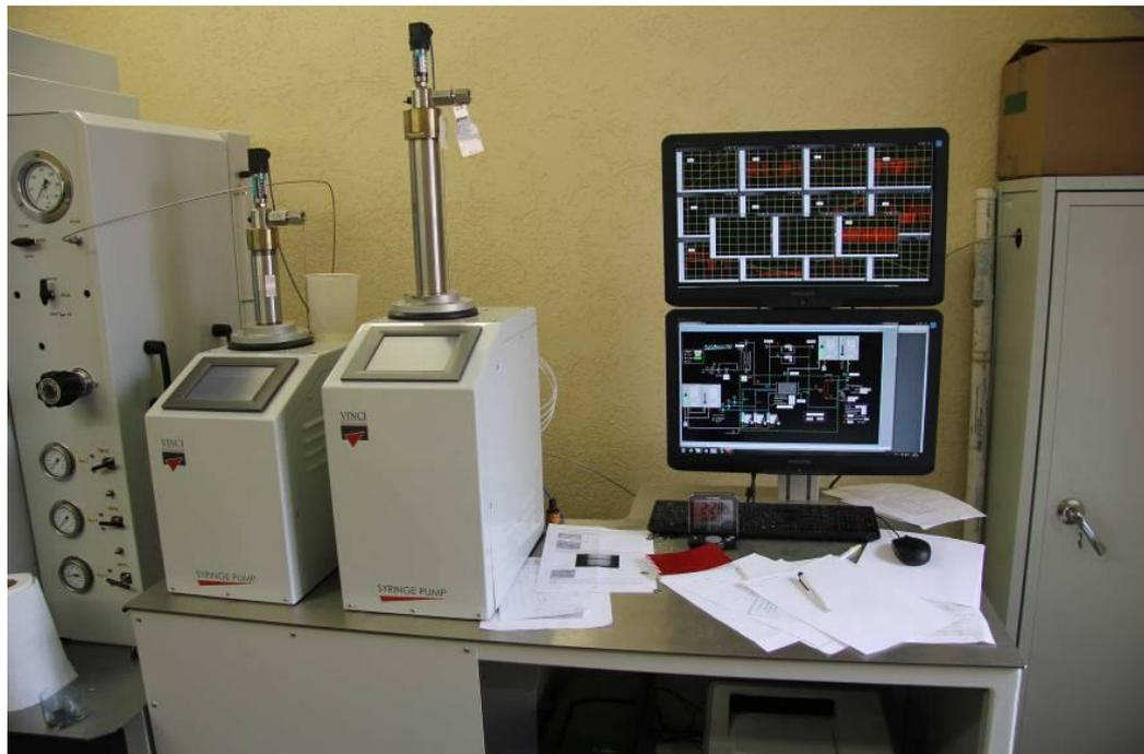
Рисунок 3.21 – Внешний вид насосного блока и пульта управления установки AutoFlood-700
