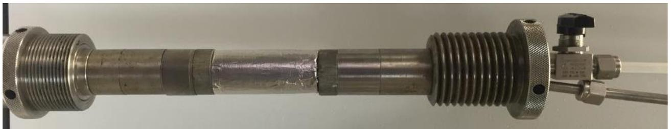
Рисунок 3.24 – Внешний вид внутренней части конструкции модернизированного кернодержателя для исследования высоковязких блокирующих составов (в том числе с наполнителем-кольматантом)
