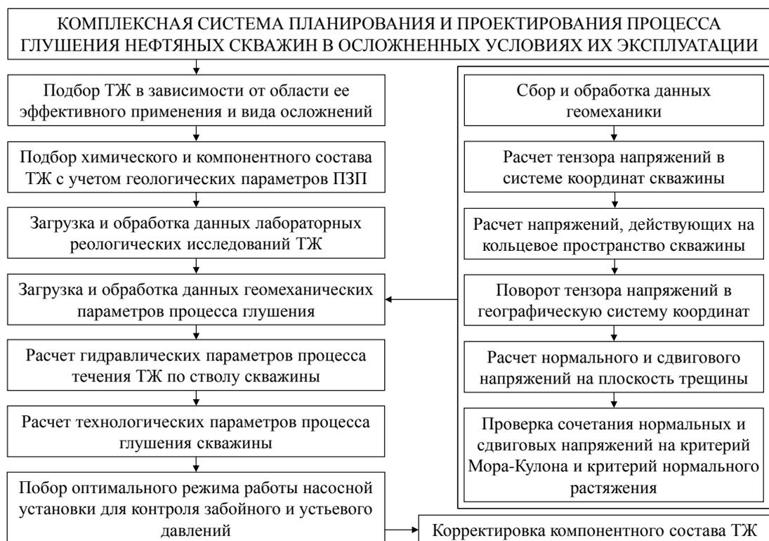
Рисунок 4.36 – Комплексная система сопровождения процесса глушения нефтяных скважин в условиях трещинно-поровых пород-коллекторов
