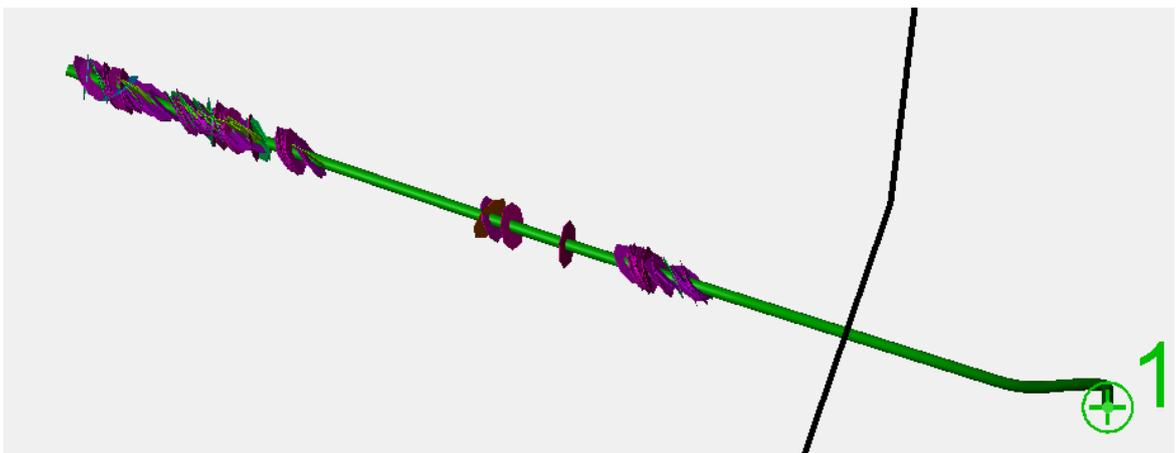
Рисунок 2.14 – Профиль скважины №1 с трещинами, неравномерно пересекающими ствол скважины под разными углами
