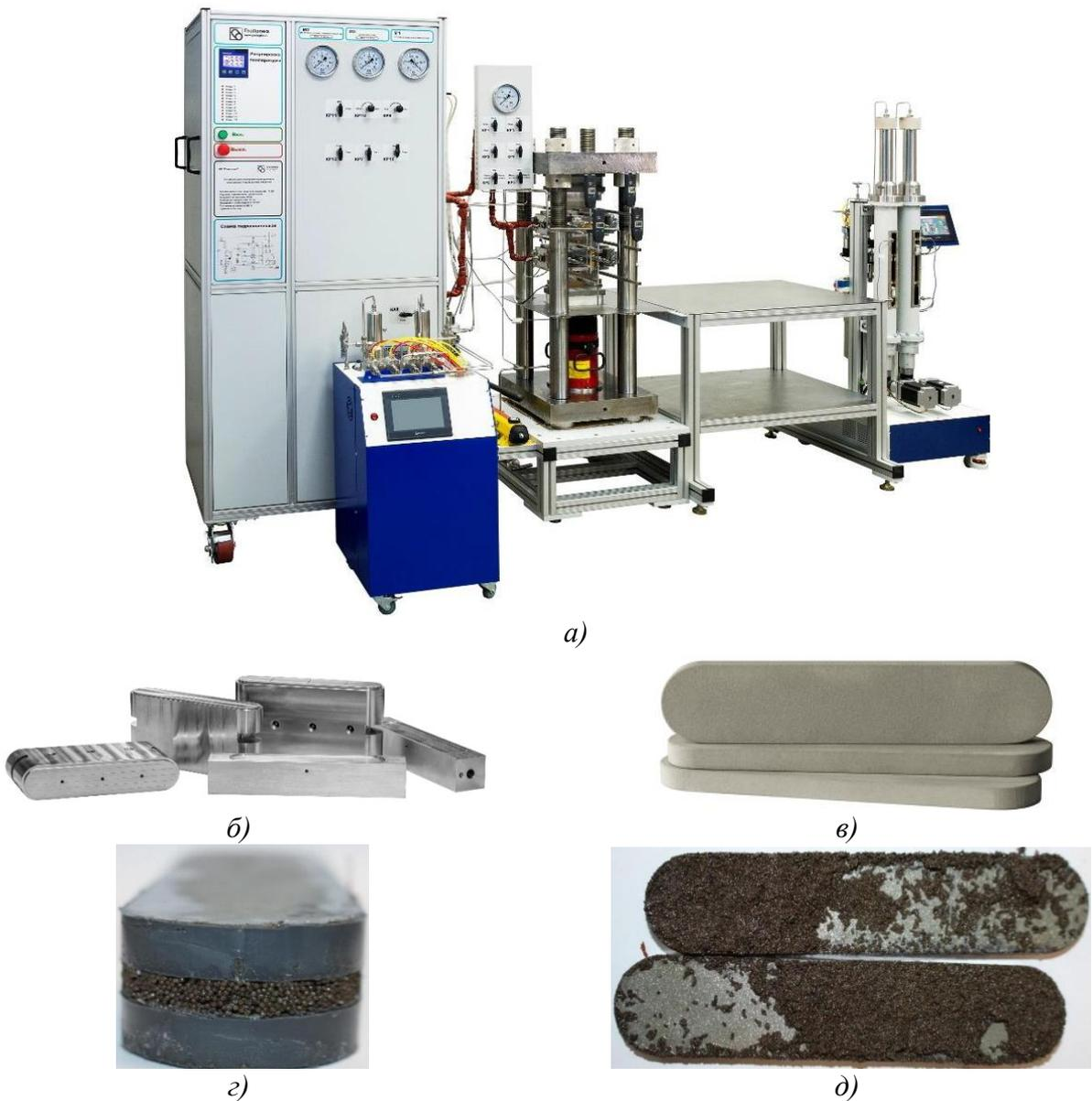
Рисунок 3.27 – Внешний вид установки «ПИК-API RP 61» (а) с ячейкой проводимости пропантной пачки (б) для размещения пластин керна с пропантом (в-д) [286]
