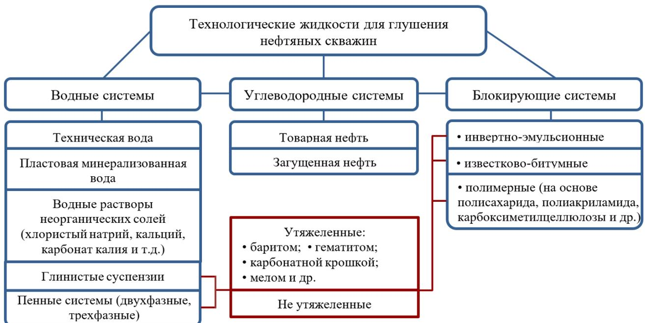
Рисунок 1.2 – Технологические жидкости для глушения скважин [45]
