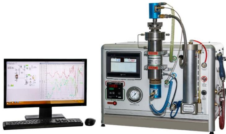
Рисунок 3.12 – Автоматизированный прибор для измерения пористости и проницаемости ПИК-ПП
