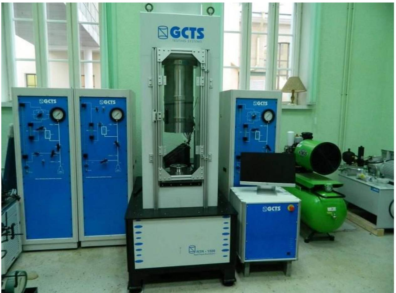
Рисунок 3.33 – Сервогидравлическая установка GCTS RTR 1500
