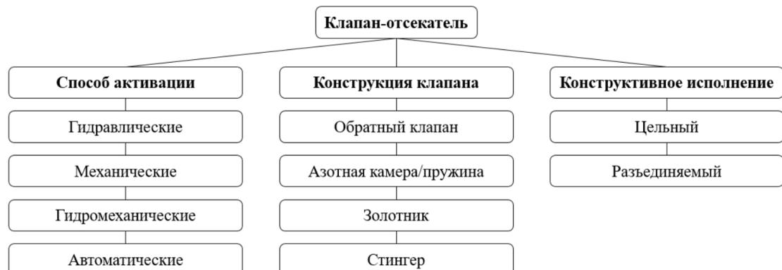
Рисунок 1.7 – Классификация скважинных клапанов-отсекателей [76, 138, 193, 201, 340]
