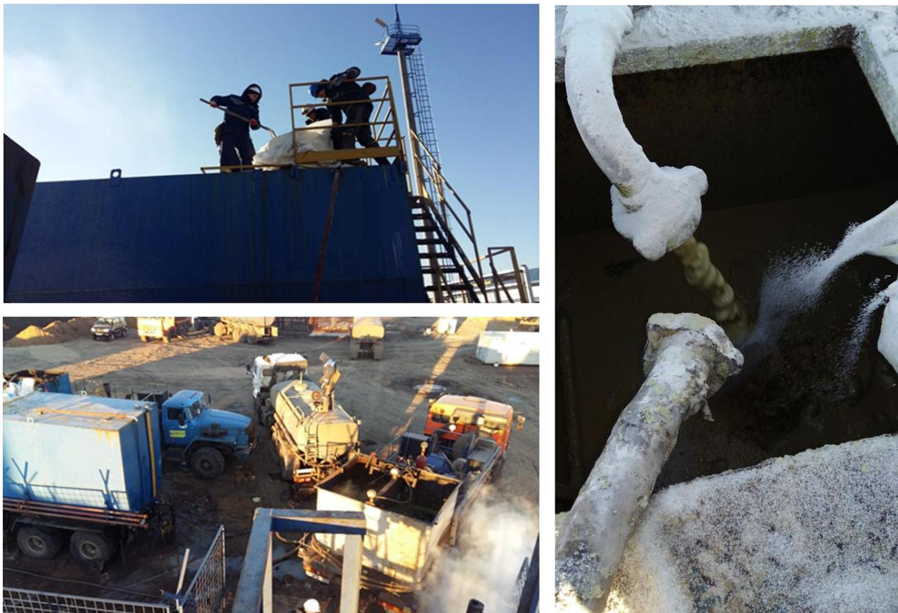
Рисунок 5.7 – Процесс приготовления блокирующего состава ОВНЭ-МК в промышленных условиях
