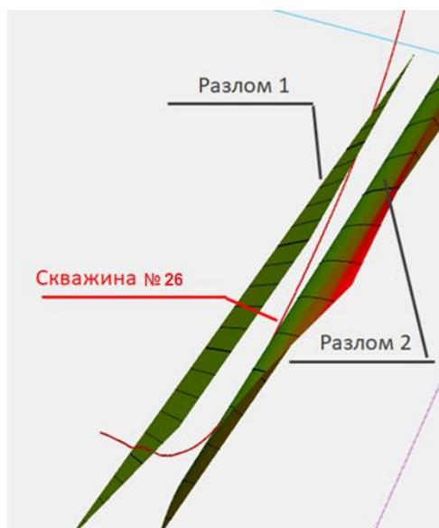
Рисунок 2.31 – Визуализация разломов, пересекающих скважину № 26
