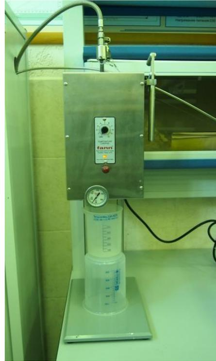
Рисунок 3.8 – Высокотемпературный фильтр-пресс высокого давления
