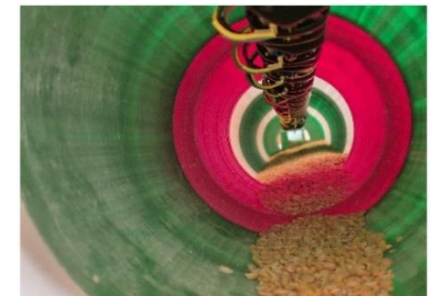
Рисунок 6 – Определение угла динамического откоса с помощью системы технического зрения
