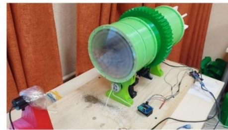
Рисунок 6 – Определение угла динамического откоса с помощью системы технического зрения
