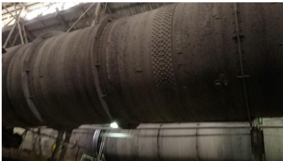
Рисунок 1.1 – Фото ТВП для спекания нефелиновой шихты с известняком (фото автора)
