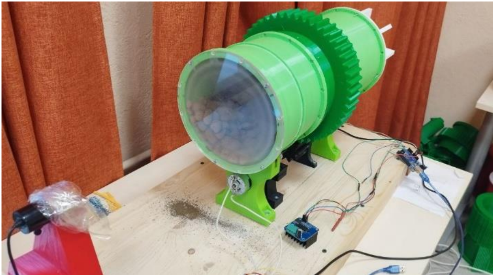
Рисунок 2.6 – Лабораторная установка для исследования поперечного движения материала (фото автора)
