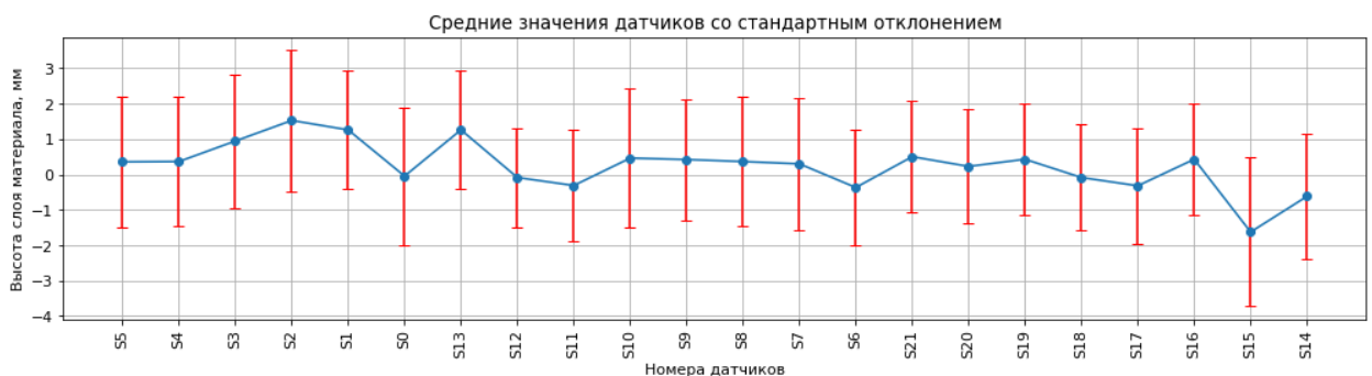
Рисунок 2.11 – Результат калибровки измерительного профиля в пустом барабане (составлено автором)
