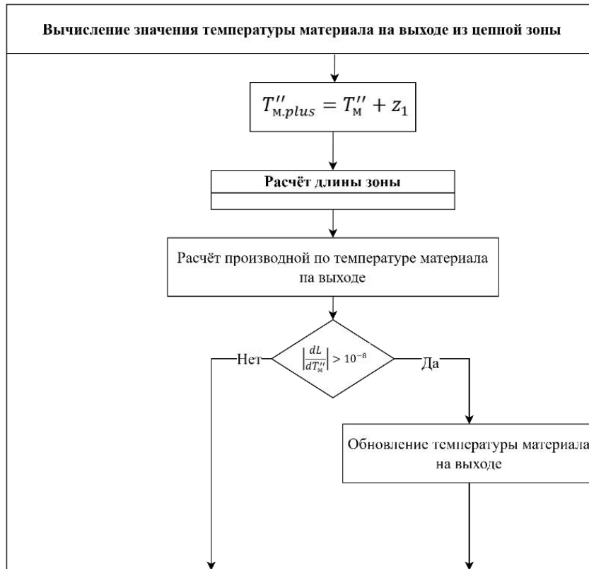
Рисунок 3.19 – Внутренний блок 2 «Вычисление значения температуры материала на выходе из цепной зоны» (составлено автором)
