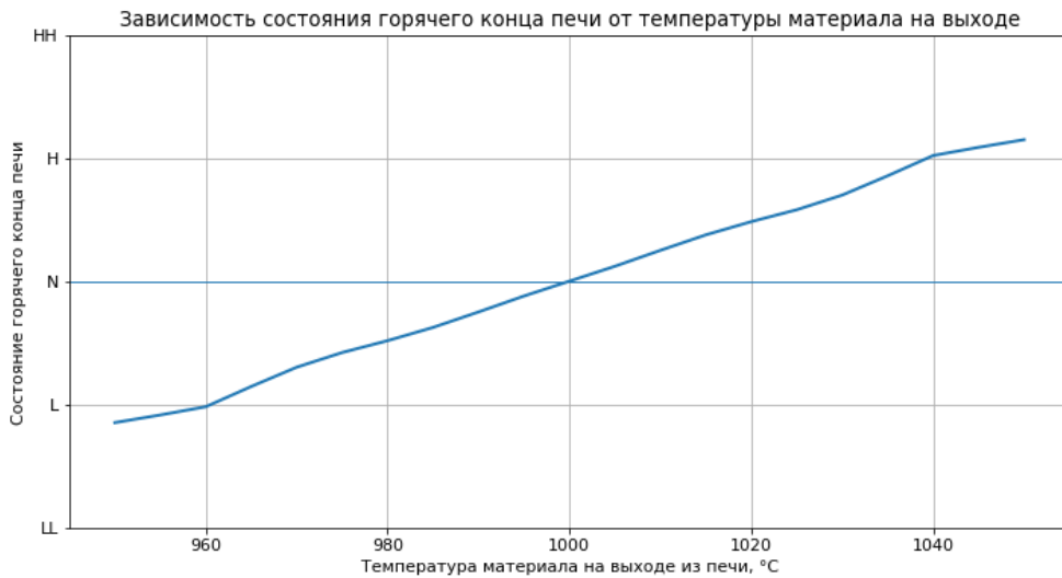
Рисунок 4.10 – Зависимость состояния горячего конца печи от температуры материала на выходе (составлено автором)
