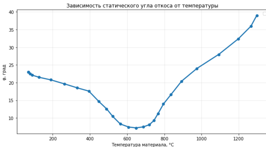
Рисунок 3.4 – Зависимость статического угла откоса материала \varphi от температуры материала [29]
