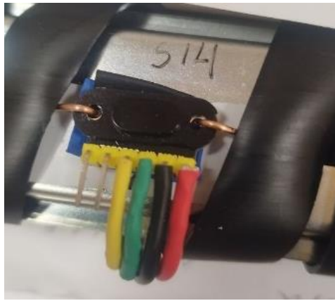
Рисунок 2.9 – Измерительное устройство TOF050C, закрепленное на металлическом профиле (фото автора)
