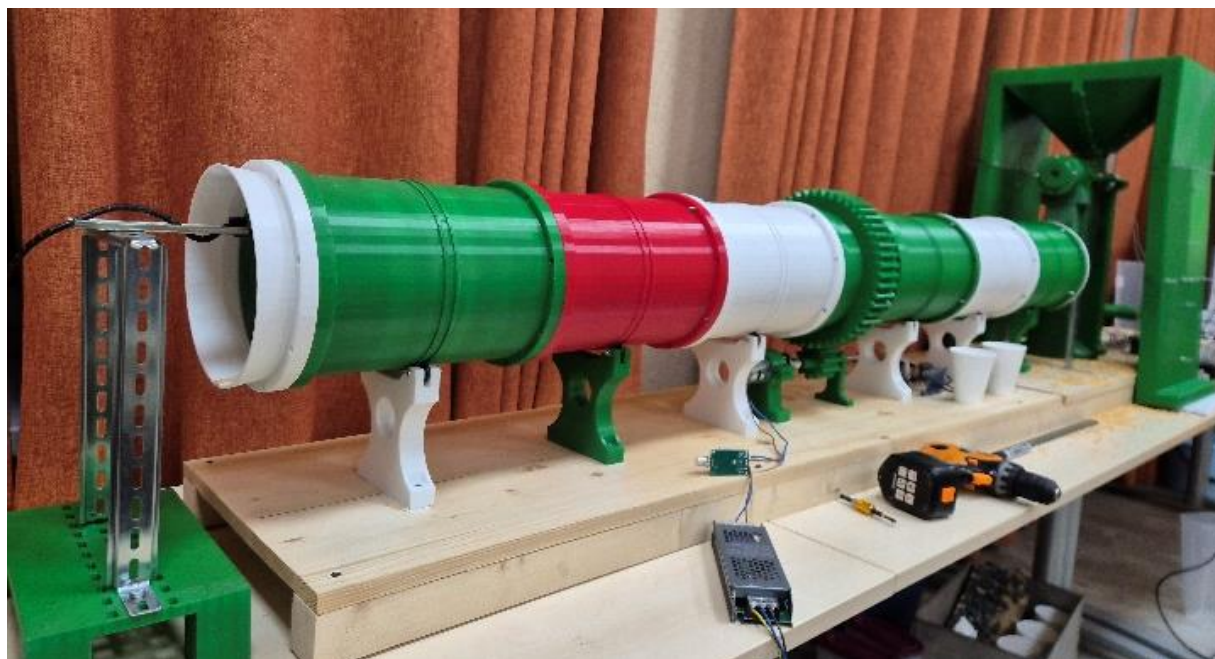
Рисунок 2.4 – Физическая модель осевого движения материала в ТВП (фото автора)
