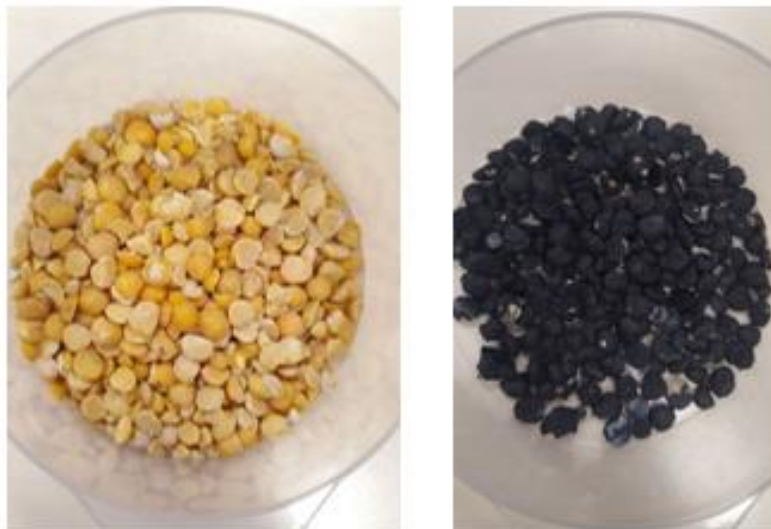
Рисунок 2.13 – Материал опыта (слева) и трассирующий материала (справа) (фото автора)
