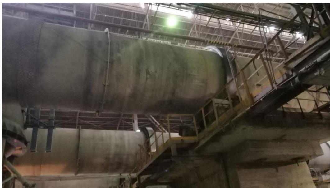
Рисунок 1.2 – Фото ТВП для спекания нефелиновой шихты с известняком (фото автора)
