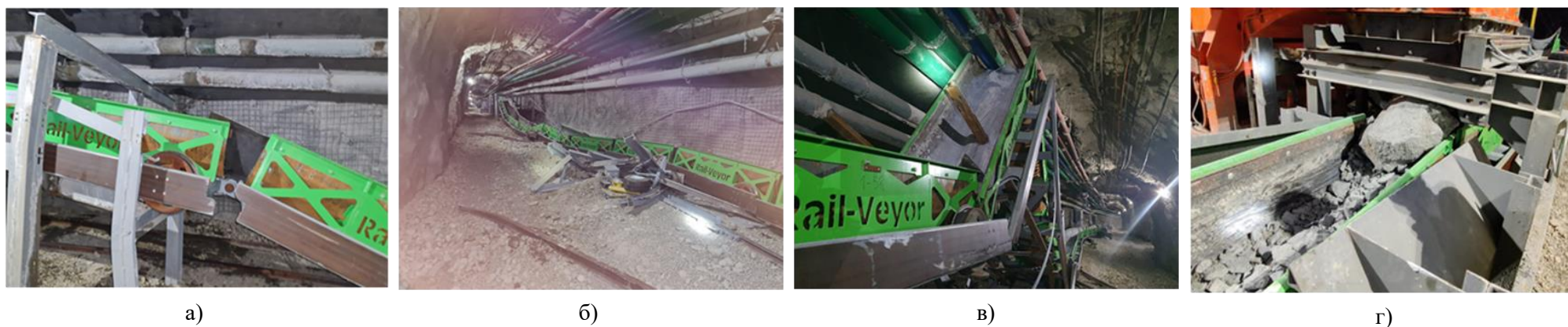
Рисунок 2 – Аварийные ситуации конвейерного поезда (Rail-Veyor)
