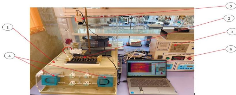
Рисунок 4 – Электролитическая установка для обнаружения дендритных осадков
