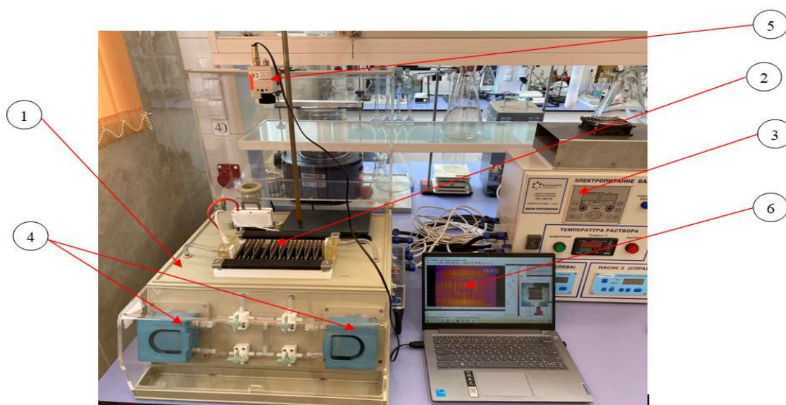
Рисунок 3.1 –Электролитическая установка для обнаружения дендритных осадков
