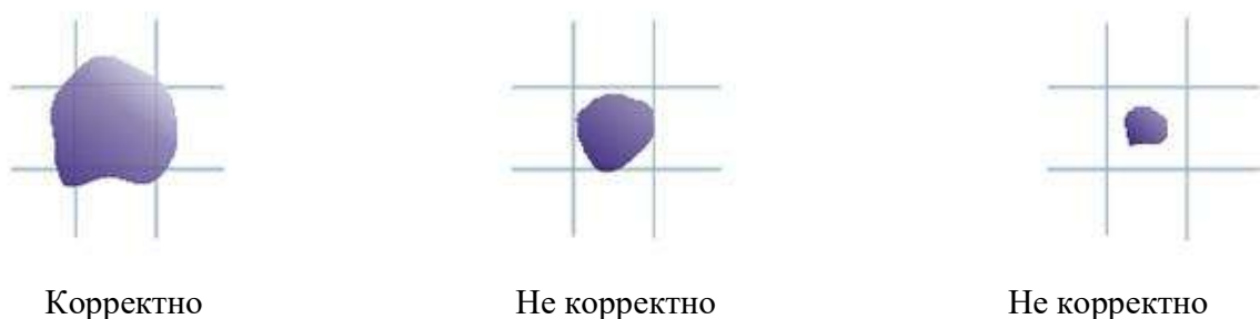
Рисунок 2.4 – Корректное измерение температуры объекта.
