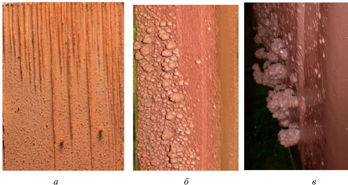
Рисунок 3.2 – Формы дендритных образований на поверхности катода[51-52] (x10): а – игольчатые; б – коагулированные остатки шлама; в- дендритные
