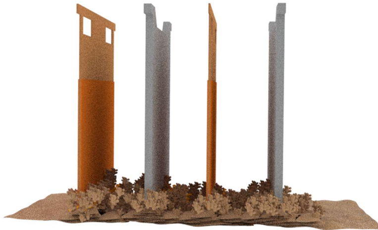
Рисунок 4.7 – Модель полного замыкания электродов при касании осадка нижней части электродов
