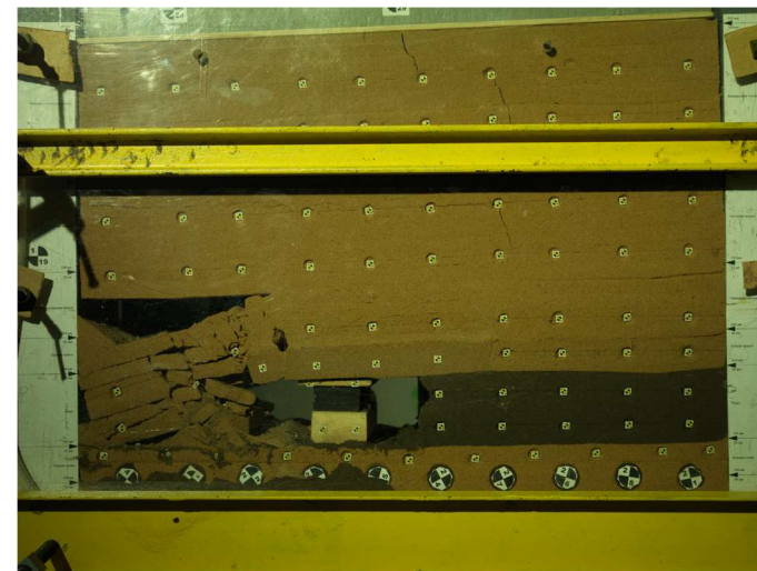
Рисунок 6 – Состояние массива при величине заделки 4 м (мощность пласта)
