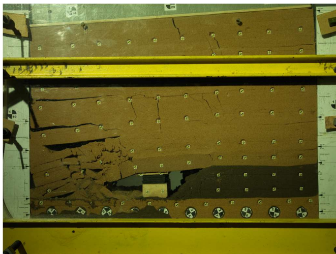
Рисунок 7 – Разрушение краевой части пласта при уменьшении величины заделки
