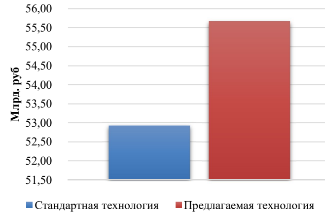
Рисунок 16 – Сравнение ЧДД при реализации различных технологий демонтажа
