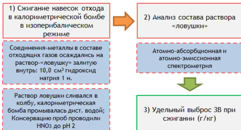
Рисунок 1 – Схема определения удельного выброса загрязняющих веществ – соединений-металлов при сжигании НЦСО
