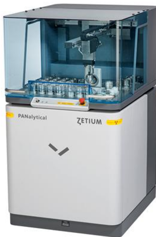
Рисунок 3.3 - Аппарат для выполнения анализов методом рентгеновской флуоресценции
