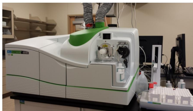
Рисунок 3.4 - Масс-спектрометрия с индуктивно связанной плазмой «ИСП-МС PerkinElmer Nexion 300X»
