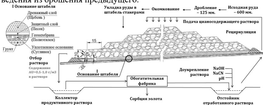
Рисунок 1 – Схема конструкции штабеля с технологическими процессами кучного выщелачивания золота
