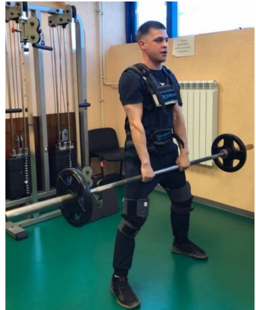
Рисунок 4.26 - Исследование по использованию экзоскелета мужчинами с разными антропометрическими характеристиками
