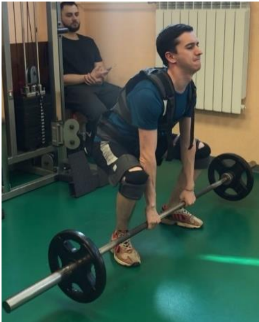
Рисунок 4.26 - Исследование по использованию экзоскелета мужчинами с разными антропометрическими характеристиками
