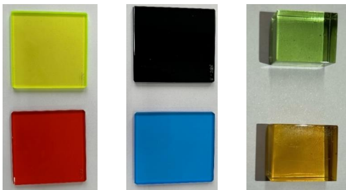
Рисунок 3 – Стекла, используемые в качестве светофильтров
