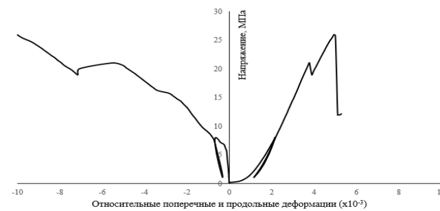
Рисунок 7 - Результаты определения статических упруго-прочностных характеристик образца ЦР-5
