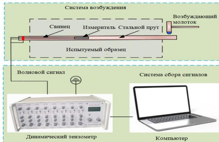
Рисунок 3.1 - Система определения частоты стального прутка [129]
