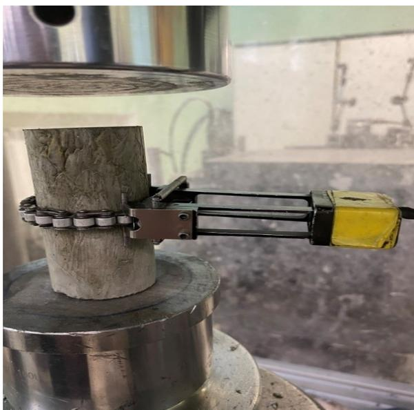
Рисунок 2.11 – Использование кругового экстензометра на практике
