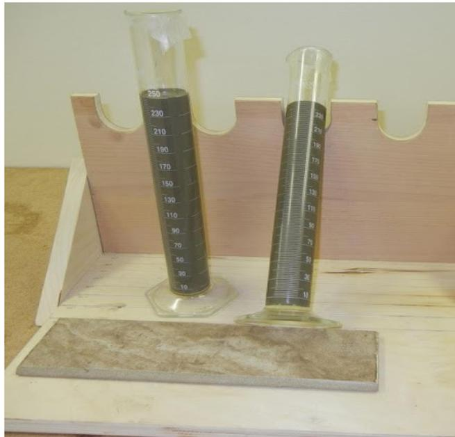
Рисунок 2.3 – Определение свободной воды в пробирке 250 мл
