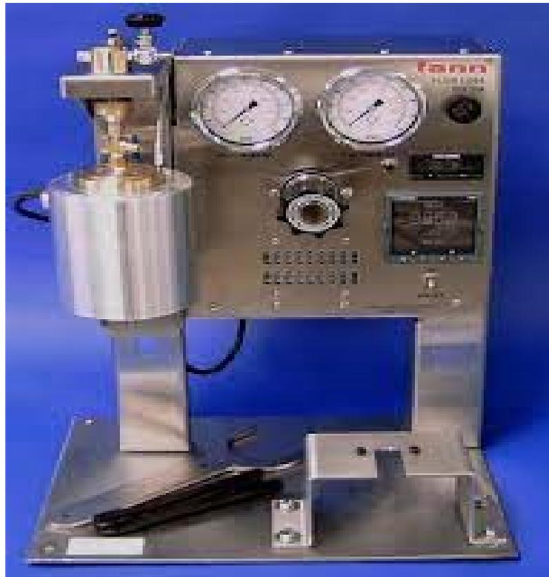
Рисунок 2.2 – API Fluid Loss tester
