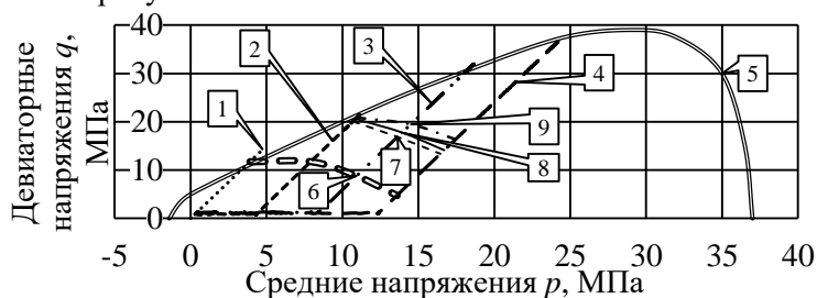
Рисунок 2 – Поверхность пластического течения: 1 – 4 – траектории нагружения (0; 4; 8 и 12 МПа); 5 – контур поверхности пластического течения; 6 – граница зоны упругих деформаций; 7 – 9 – границы зон значений относительных объемных пластических деформаций соответственно равных 0,0075, 0,01 и 0,015
